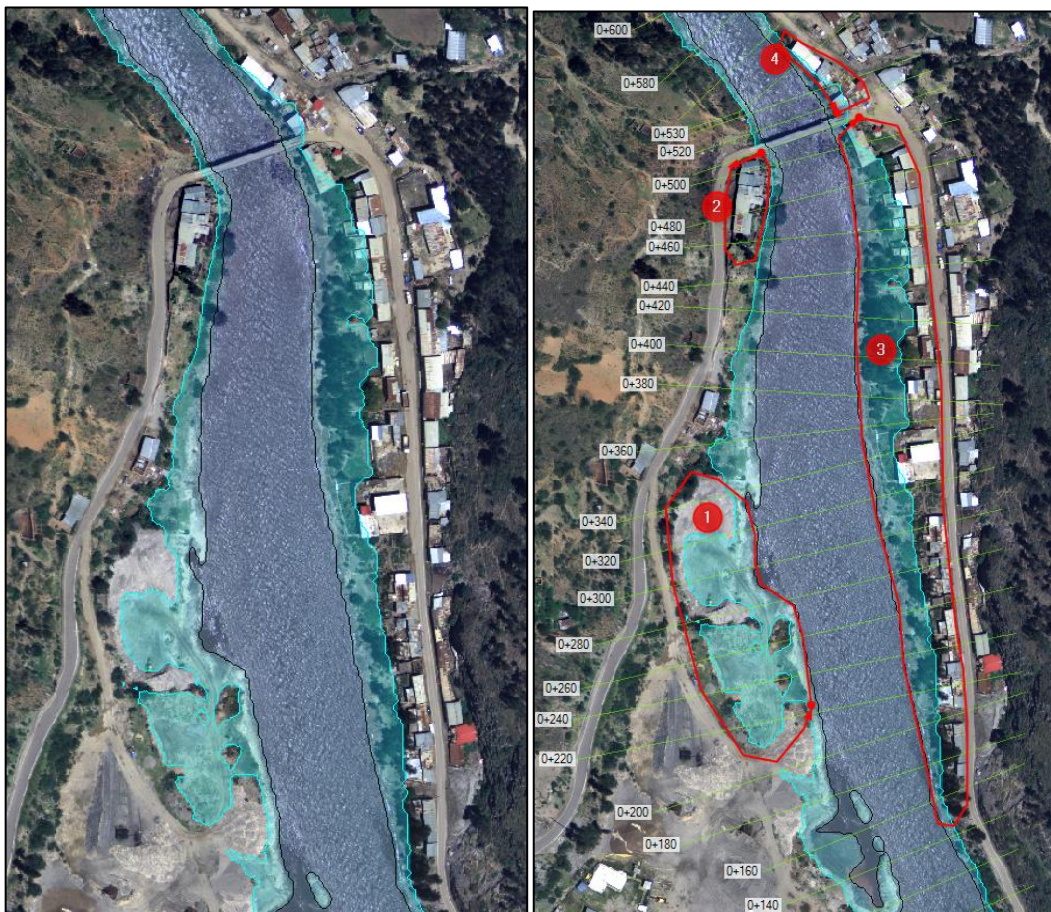
Figura 147: Identificación en planta de las zonas críticas en el tramo de estudio
