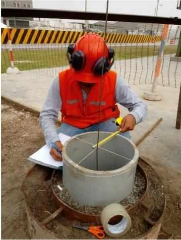
**Figura 28: Registro de las desviaciones (prueba de verticalidad)**
