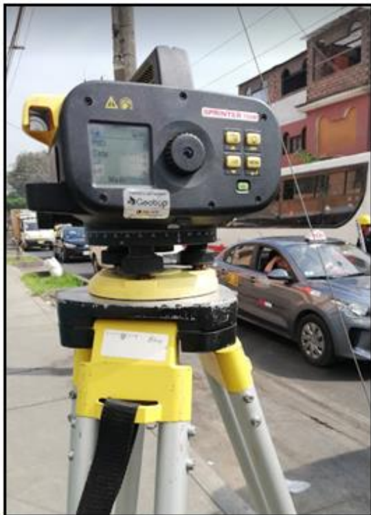
Figura N° 16: Vista del Nivel Electrónico marca LEICA Sprinter 150 m
