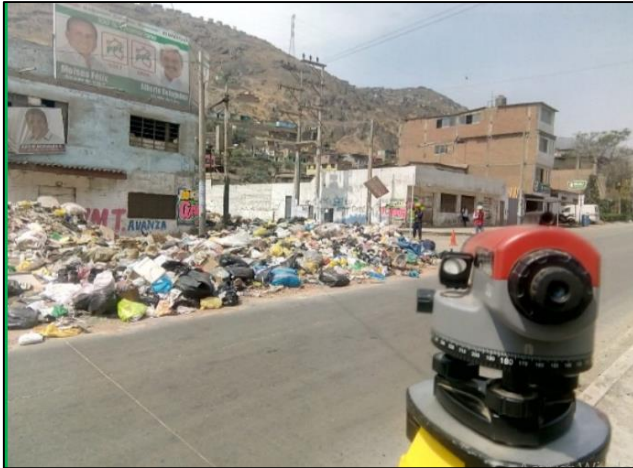
Figura N° 30: Nivel automático empleado en los meses de Octubre a Diciembre 2018
