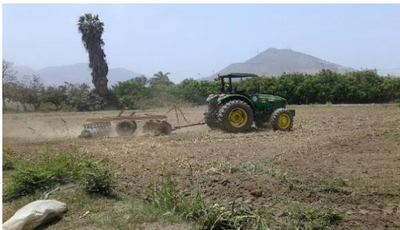
**Figura 11: Grada pesada de discos**
