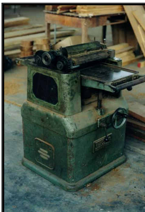
Figura 5 Cepilladora generadora de los residuos de madera utilizados para la elaboración de los tableros.
