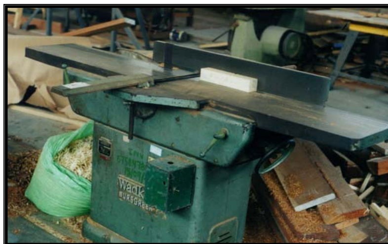
Figura 4 Garlopa generadora de los residuos de madera utilizados para la elaboración de los tableros.
