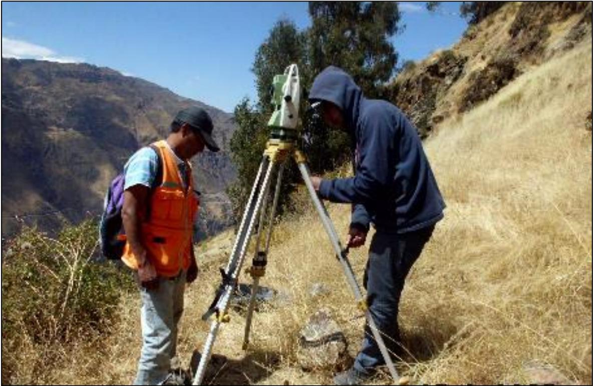
**Figura 9: Levantamiento topográfico con Estación total Leica TS 06**
