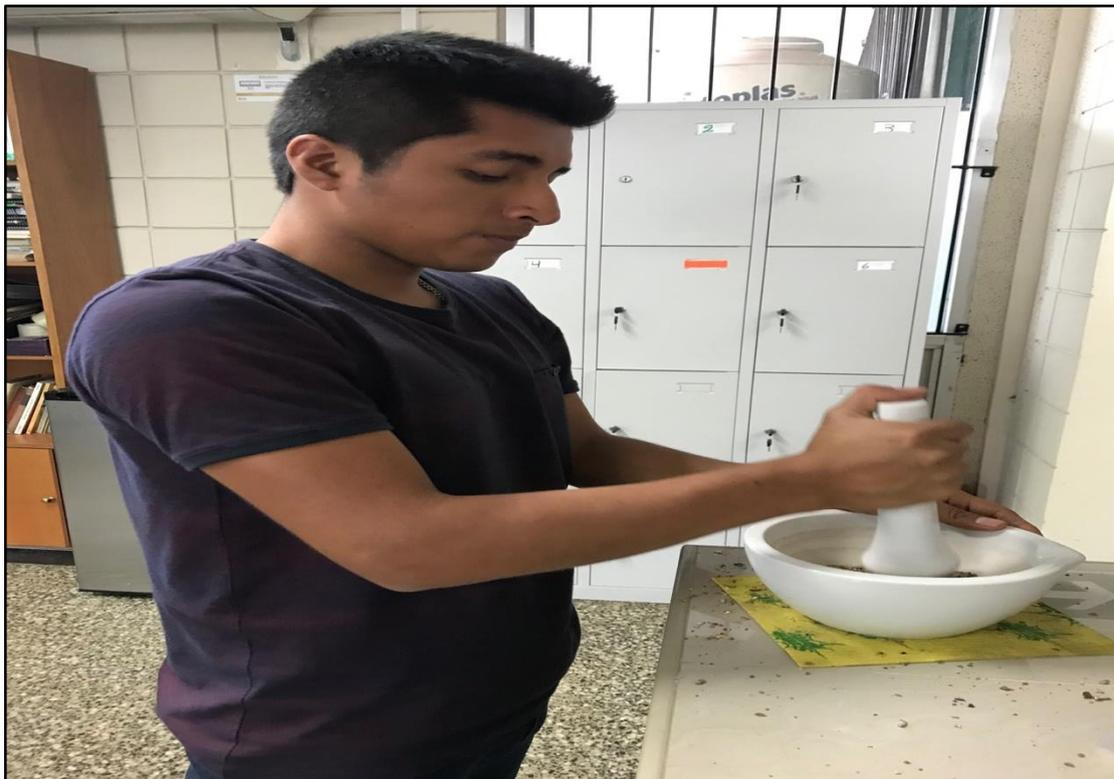
**Trituración de hojuelas secas para obtención de cantidad de nitrógeno en tuberculos**
