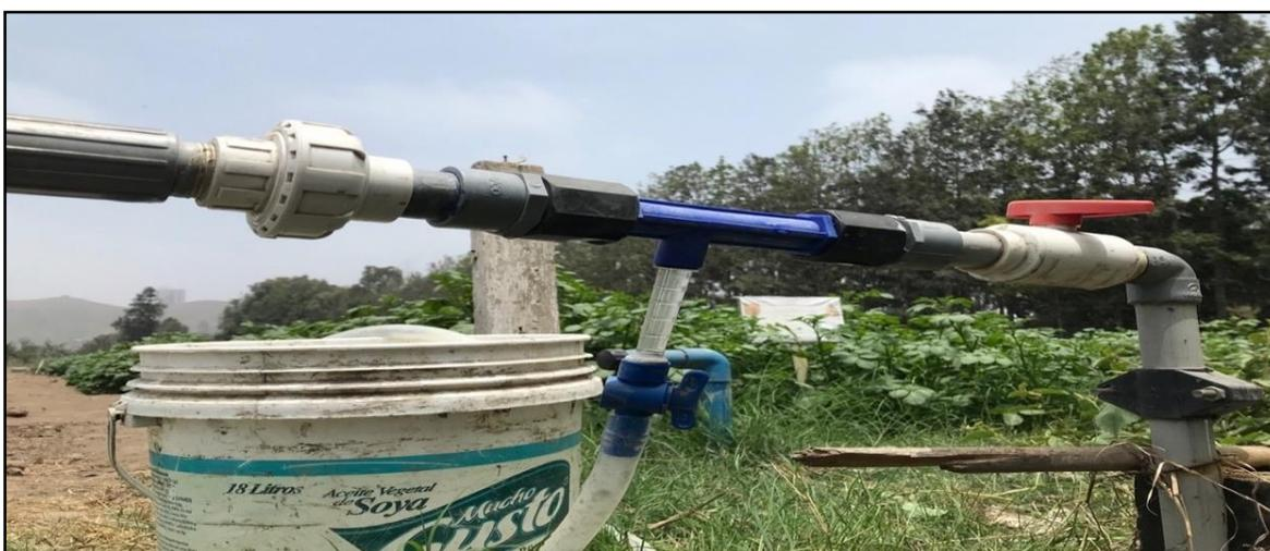
**Figura 13: Sistema de inyección tipo Venturi**
