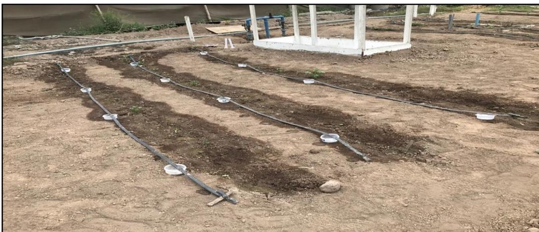
**Figura 9: Prueba de coeficiente de uniformidad en campo**
