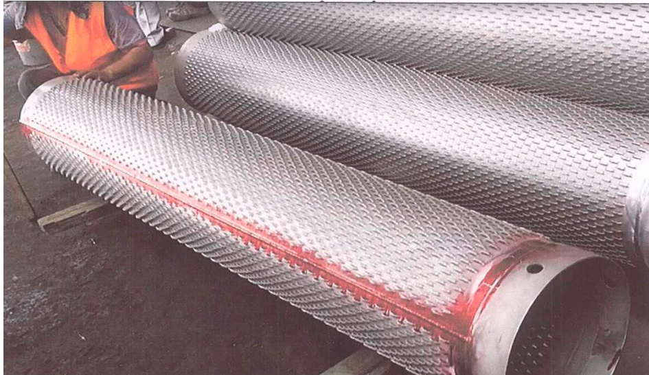
Figura 21: Aplicación del líquido penetrante
