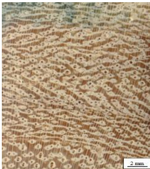
Figura 38: Vista macroscópica de la sección transversal de Hymenolobium nitidum
