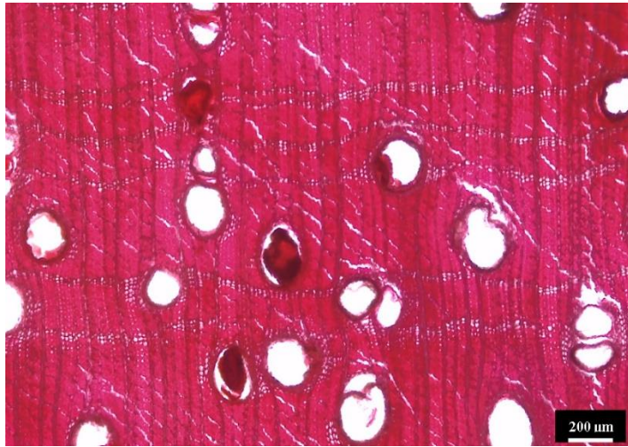
Figura 46: Sección transversal de Macrobium microcalyx
