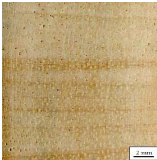
Figura 66: Vista macroscópica de la sección transversal de Virola albidiflora
