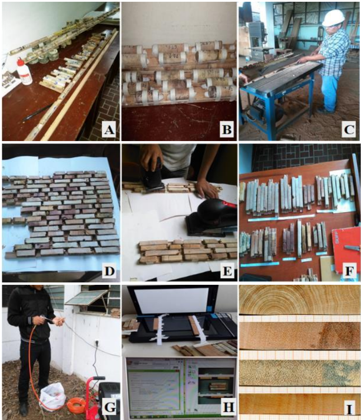
Figura 5: Proceso de acondicionamiento de las muestras de madera, para el análisis de anillos de crecimiento
