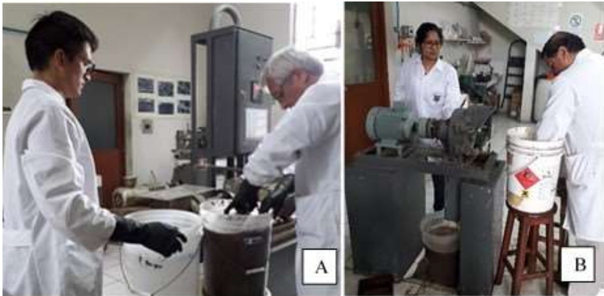
Figura 15: Desfibrado de las astillas de madera de bolaina blanca: A – primera etapa y B –segunda etapa
