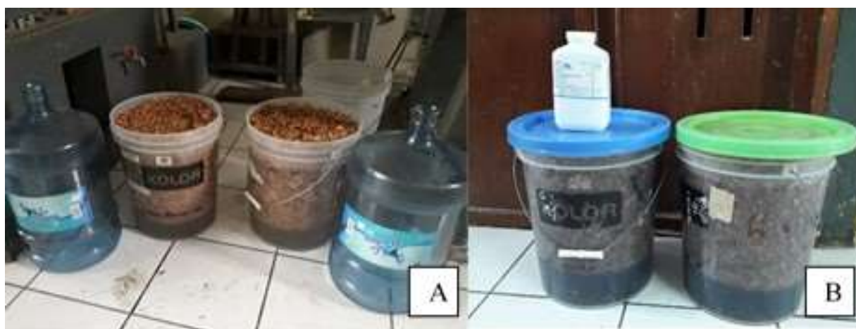
Figura 14: Pretratamiento de las astillas de madera de bolaina blanca durante 24 horas A - con agua potable y B - con hidróxido de sodio 6,67 g/L
