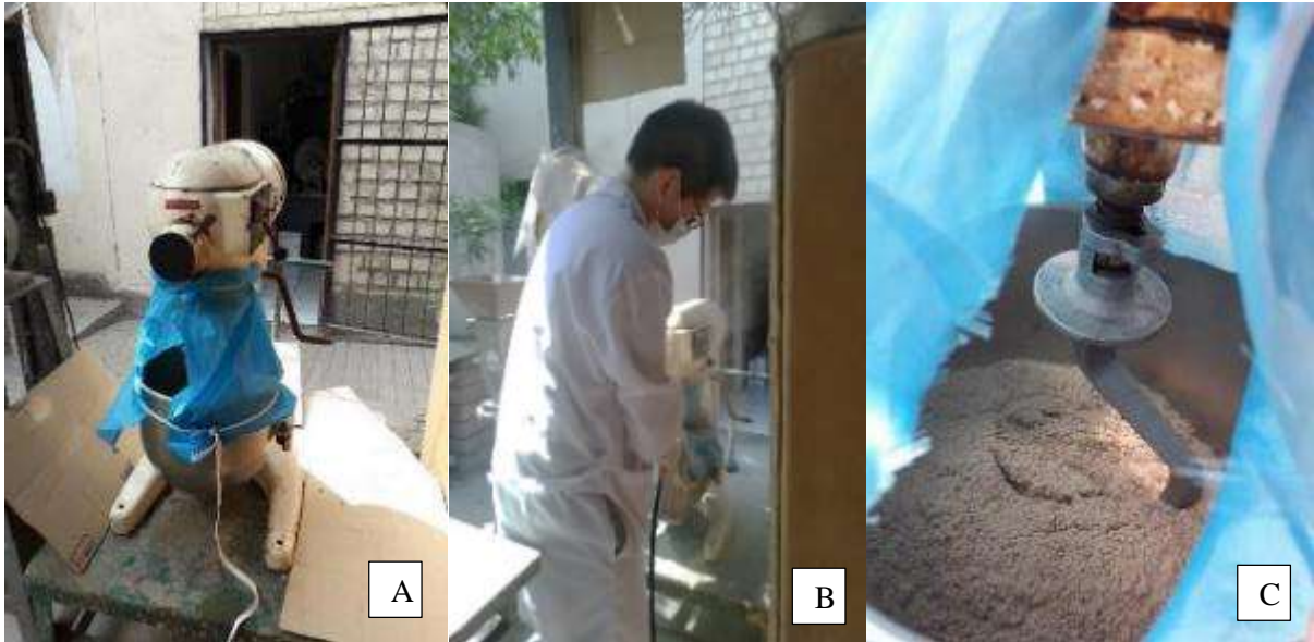
Figura 17: Aplicación de los adhesivos en las pulpas: A - mezcladora con pulpa cubierta; B - aplicación del adhesivo con la pistola y C - mezclado de pulpa con el adhesivo
