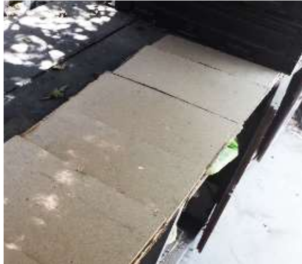
Figura 20: Tableros MDF en acondicionamiento
