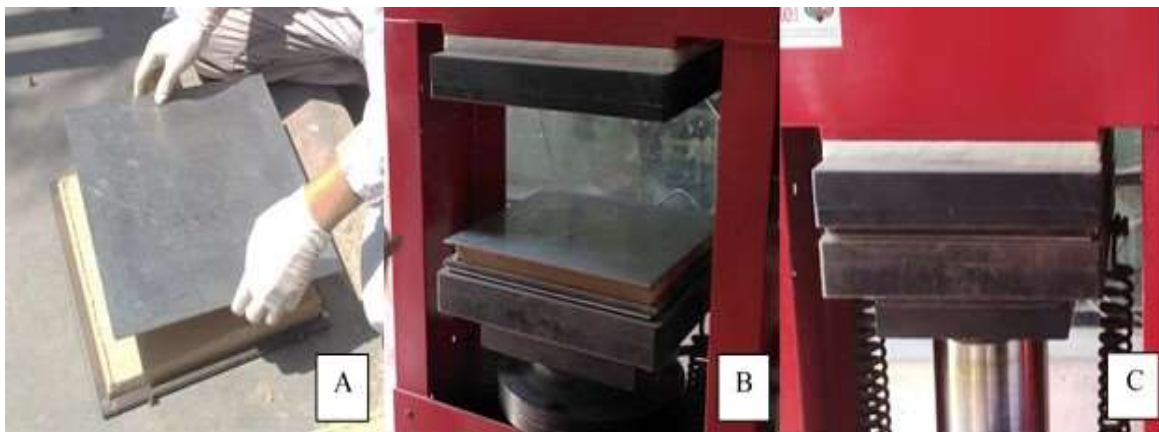
Figura 19: Prensado en caliente: A- conjunto armado: MAT, planchas y marco de metal, B - posicionamiento en la prensa y C - prensado en caliente propiamente dicho
