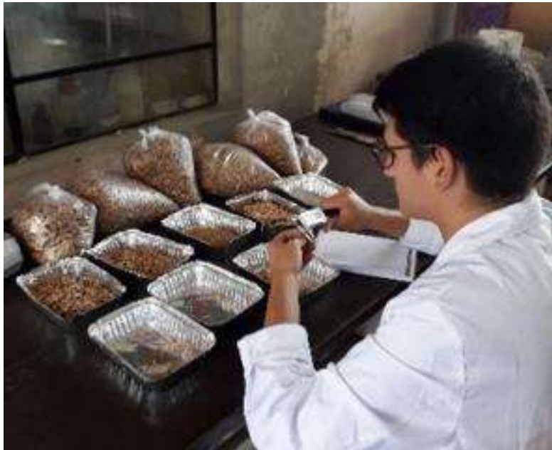
Figura 13: Medición del espesor de astillas de madera de bolaina blanca
