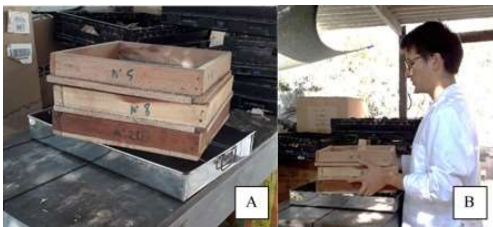
Figura 12: Clasificación granulométrica de las astillas de madera de bolaina blanca: A - tamices N° 5, 8 y 20 y B - tamizaje manual
