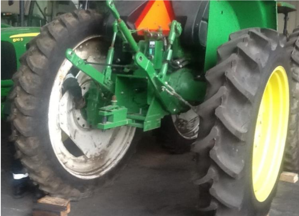
Figura 14: Diferencia de neumáticos y aros Tractor modelo 5090EH.
