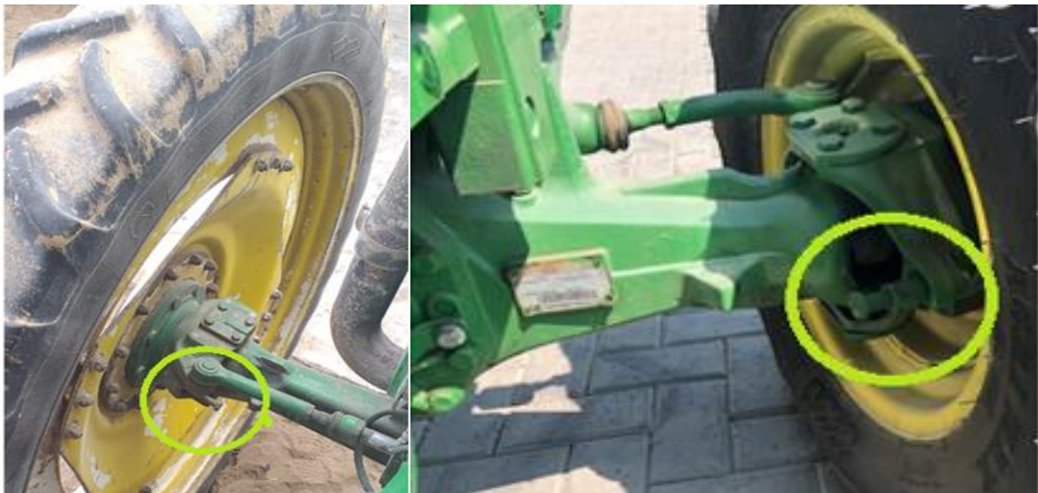
Figura 15: Perno para restricción de movimiento de ruedas.
