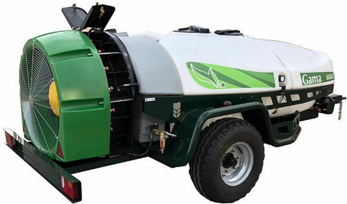
Figura 8: Atomizadora marca Gama modelo Olivar Plus/200.
