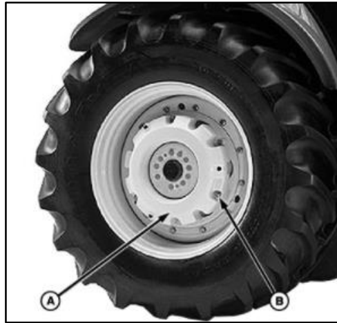
Figura 23: Lastre posterior, (A) pesa, (B) perno.
