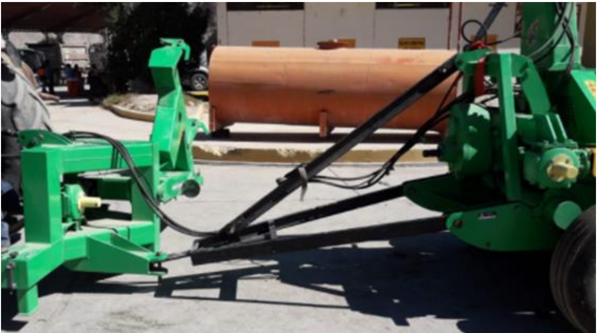
Figura 55: Acople instalado en la picadora de forraje JF AT1600.
