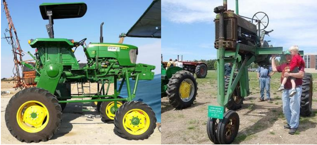
Figura 3: (A) Tractor agrícola John Deere modelo 5075E elevado a zancudo y (B) Tractor Zancudo John Deere modelo B año 1949 (B).
