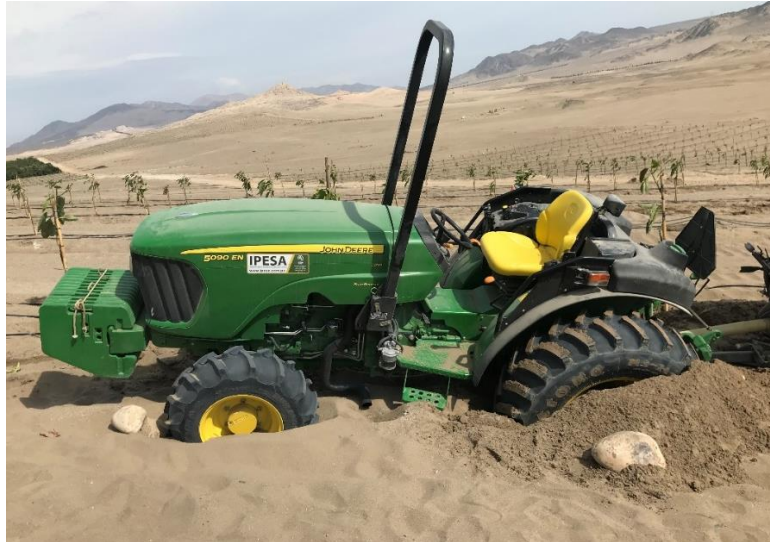
Figura 43: Atollamiento tractor 5090EN.
