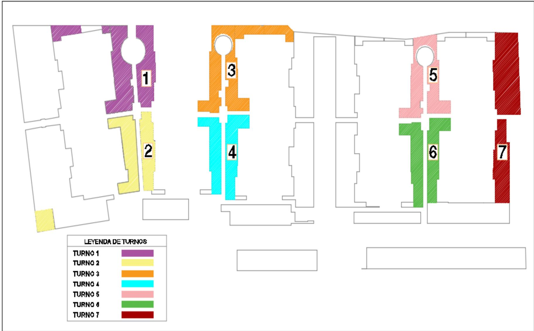
Figura 6: Turnos de operación del sistema de riego, Mirador del Golf
