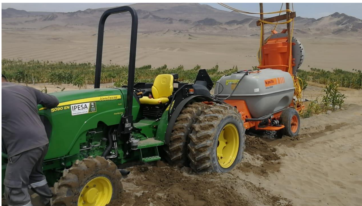
Figura 20: Tractor de trocha angosta atascado en el terreno por problemas de patinamiento y falta de potencia.
