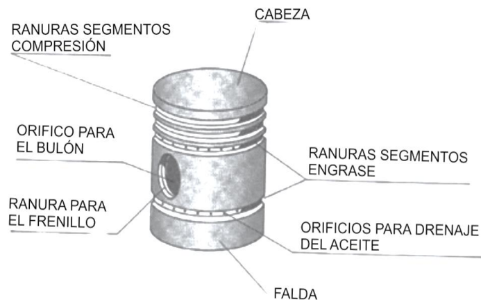
Figura 26. Pistón y denominación de sus partes. Tomado de Arnal, P. & Laguna, A. (2005).
