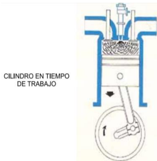
Figura 37. Esquema de un cilindro en tiempo de trabajo. Tomado de Arnal, P. & Laguna, A. (2005).
