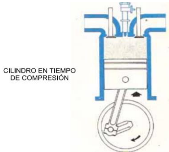
Figura 36. Esquema de un cilindro en tiempo de compresión. Tomado de Arnal, P. & Laguna, A. (2005).
