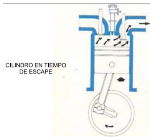
Figura 38. Esquema de un cilindro en tiempo de escape. Tomado de Arnal, P. & Laguna, A. (2005).
