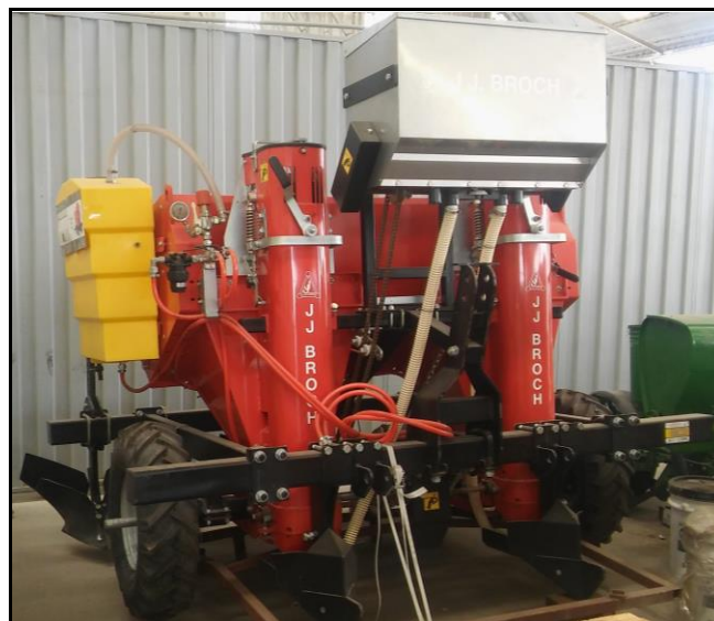
Figura 6: Plantadora de papa de dos líneas marca JJBroch.
