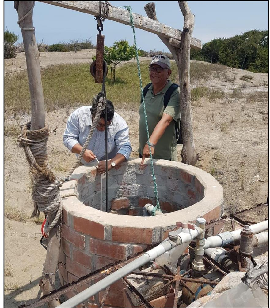
*Figura 73: Midiendo nivel estático del pozo IRHS 342*
