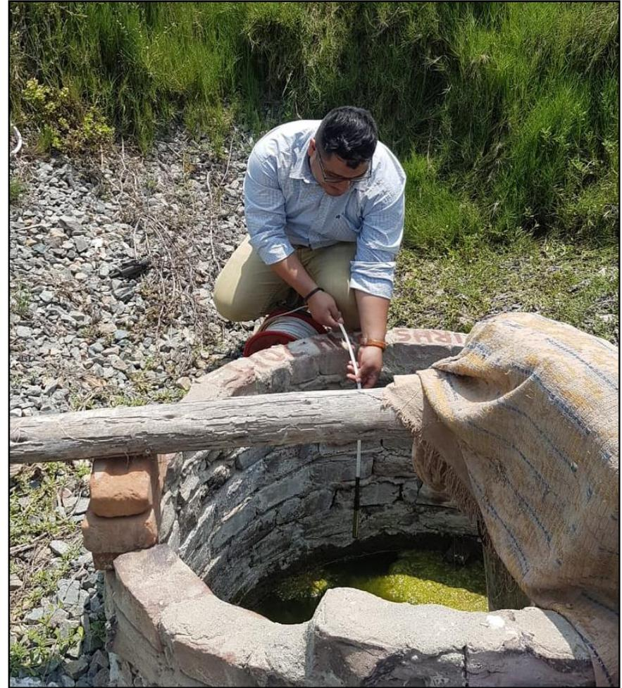
**Figura 75:** Medición del nivel estático del pozo IRHS 344
