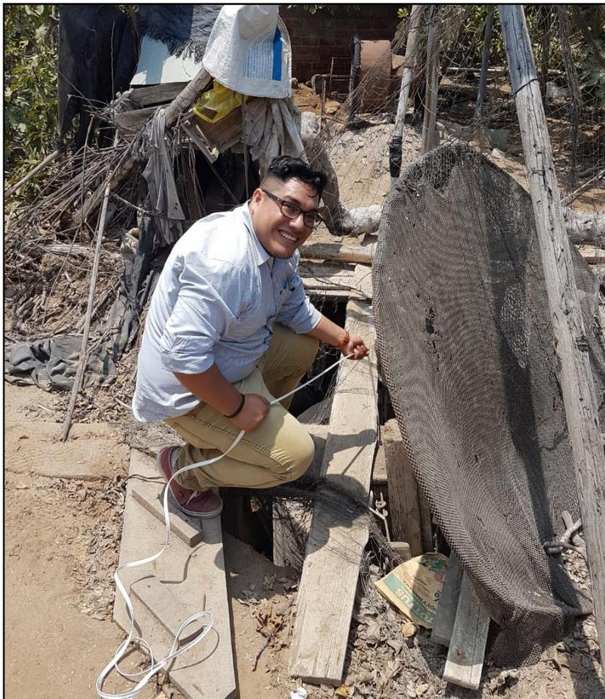
**Figura 76:** Medición del nivel estático del pozo IRHS 626
