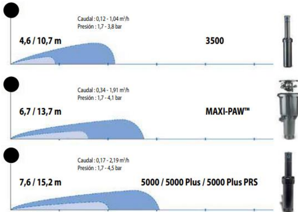
Figura 15: Radios, caudales y presiones de los rotores.
