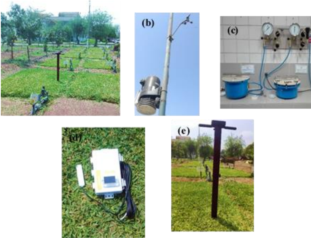
Figura 36: a) Sistema de riego por goteo subterráneo y tratamientos b) Estación automática Davis c) Ollas y platos de presión d) Sensor FDR e) Sensor TDR.
