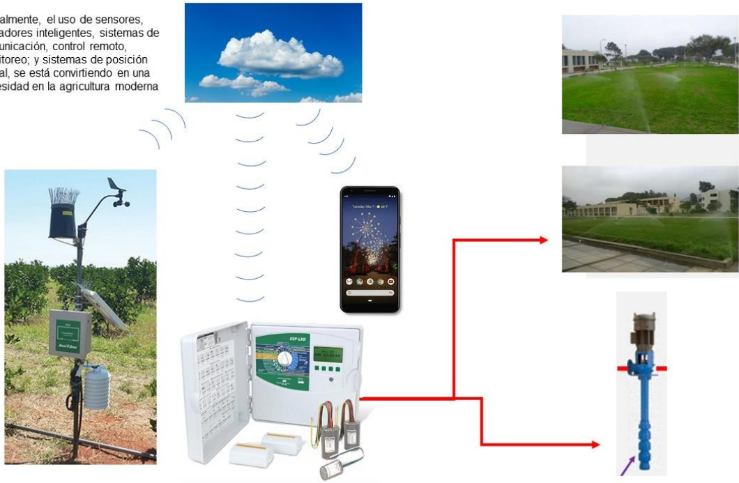
Figura 33:Automatización y telecontrol Plataforma IQ Cloud Rain Bird.
