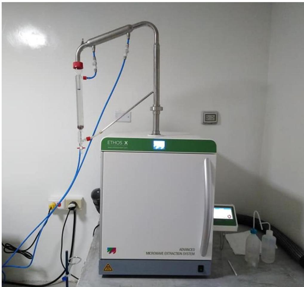
**ANEXO 5:** Equipo de destilación mediante arrastre con vapor a nivel laboratorio
