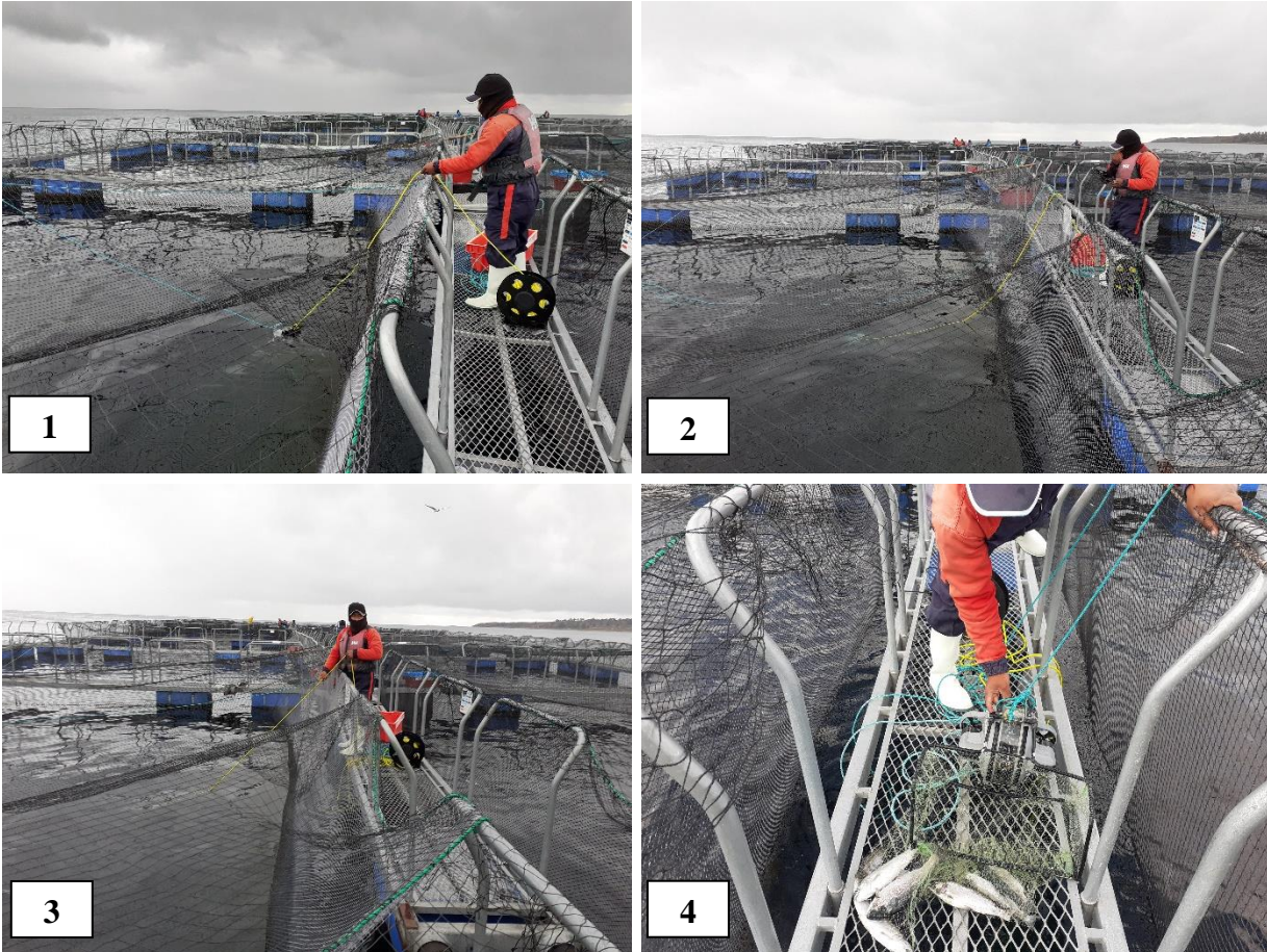
1. Sumergimiento del ROV a la jaula objetivo; 2. Búsqueda de los peces muertos en la base de la jaula con ayuda del controlador del ROV; 3. Maniobras del operador para la extracción de todos los peces muertos ubicados; 4. Extracción de la mortalidad con ayuda del ROV.
