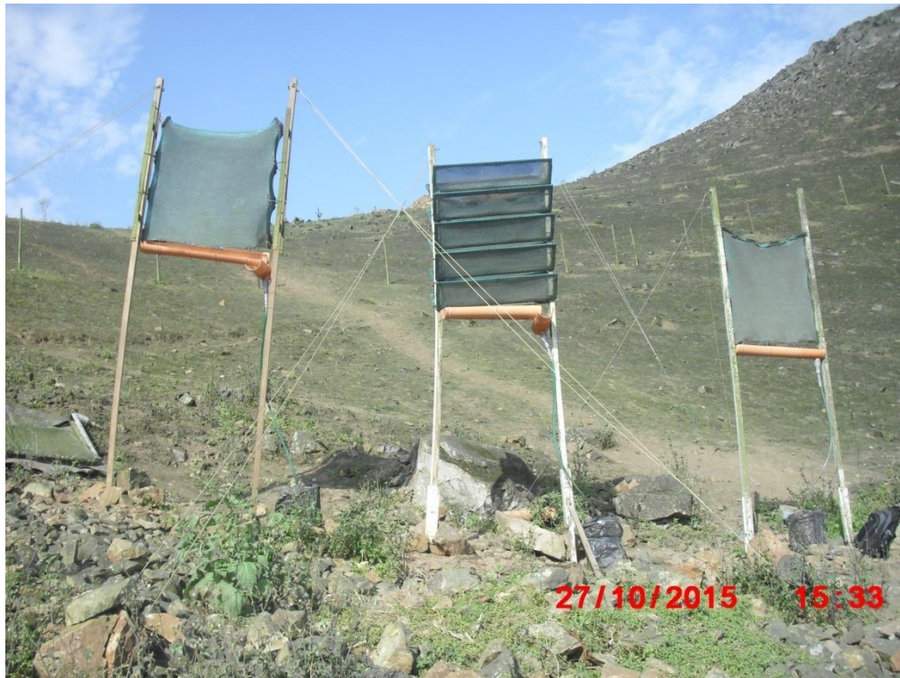
Figura 33: A la izquierda: modelo SFC, al centro modelo Box y a la derecha modelo Árbol. Los modelos fueron instalados en cresta de cerro del pueblo joven Flor de Amancaes.
