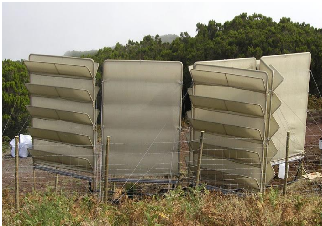
Figura 3: Bandejas colectoras y componentes del colector tipo Árbol implementado en Tenerife, España.
