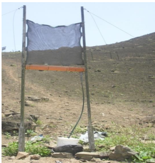
Figura 5: Diseño de los componentes de un neblinómetro SFC.
