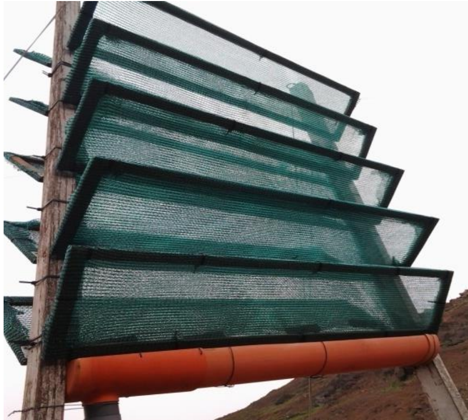
Figura 32: Colector Árbol instalado en el campo. 10 de bandejas en postes colocadas de manera alterna a cada lado del poste.
