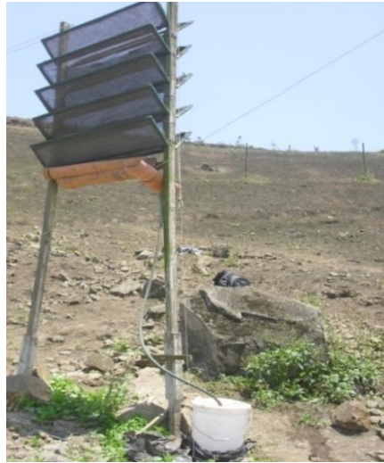
Figura 7: Diseño de los componentes del neblinómetro Árbol.
