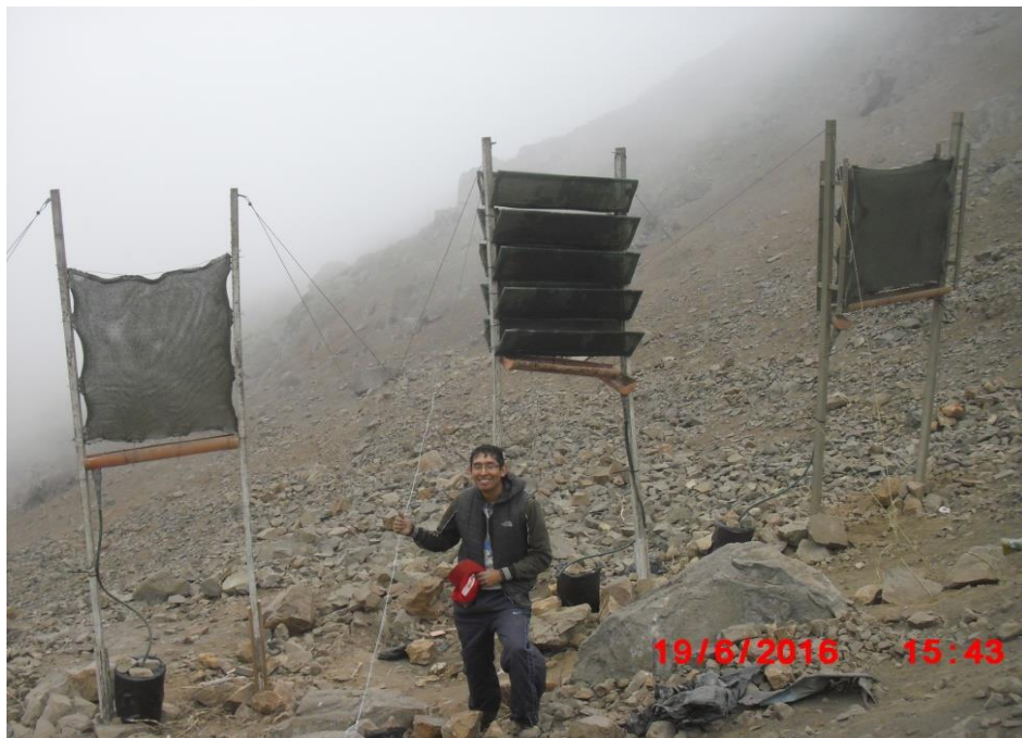
Figura 42: Colección de agua de niebla en junio del 2016. Nótese el color de la malla gris. Investigador en zona de estudio, Lomas de Villa María del Triunfo.
