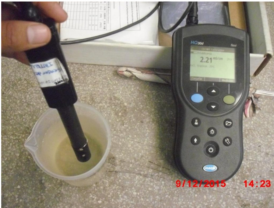
Figura 40: Monitoreo de la calidad del agua. Medición de conductividad de agua de colector SFC.
