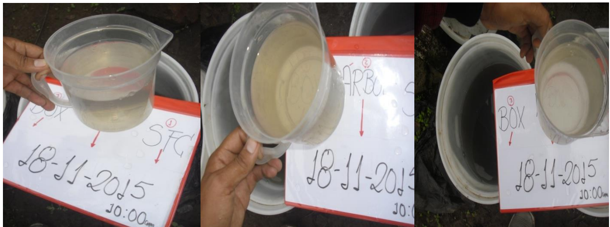
Figura 38: Jarra de medición de la cantidad del agua. Izquierda: agua de colector SFC, centro: agua de colector Árbol y derecha: agua de colector Box.
