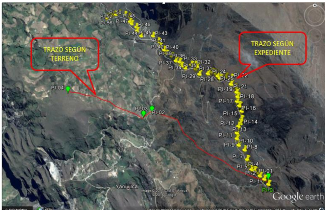
Figura 22. Vista del tramo del eje del canal expediente técnico vs levantamiento en campo.
