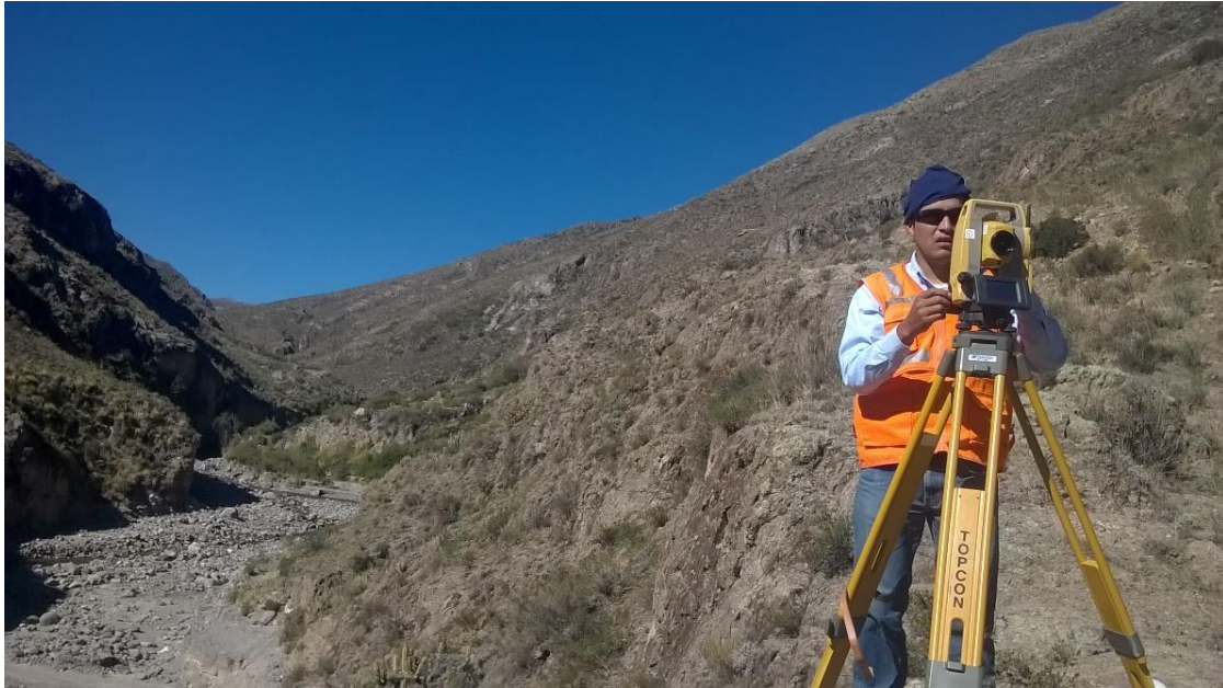
Foto 3: Levantamiento topográfico de la sección de 400 metros en la Cola del Embalse
