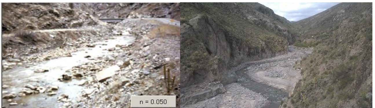
Figura 12: Características superficiales del cauce del río Torata para cálculo de coeficiente de rugosidad de Manning
