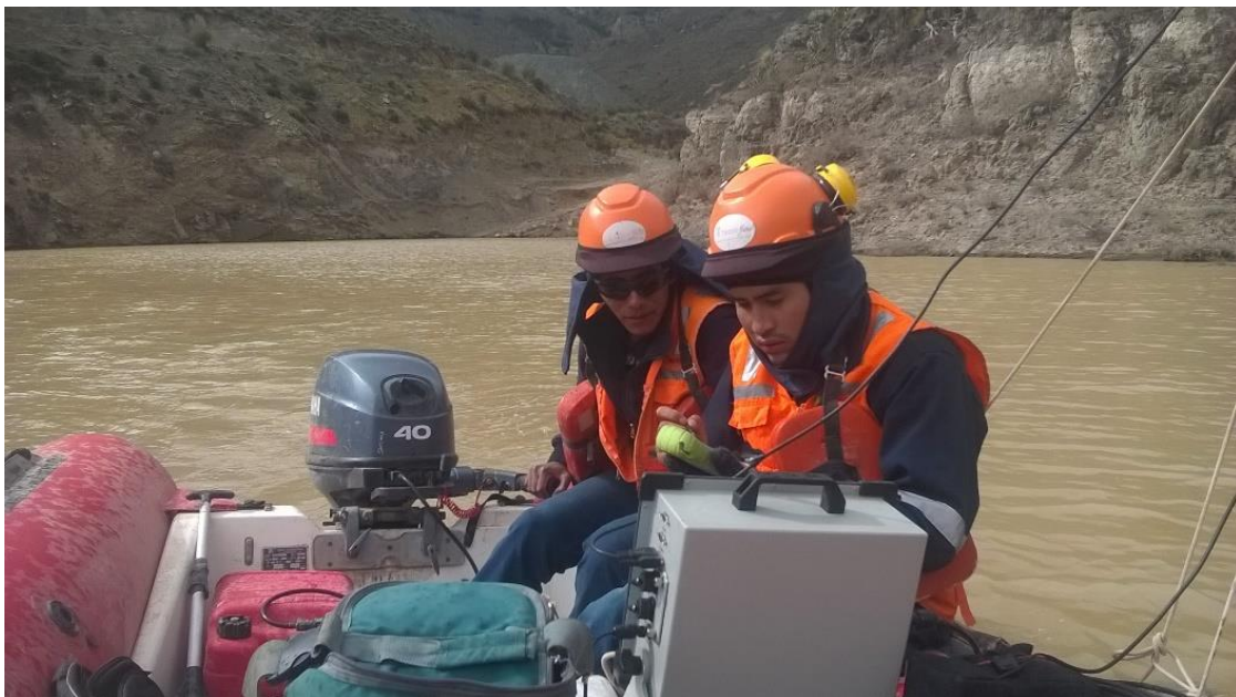
Foto 4: Levantamiento batimétrico con ecosonda y GPS diferencial
