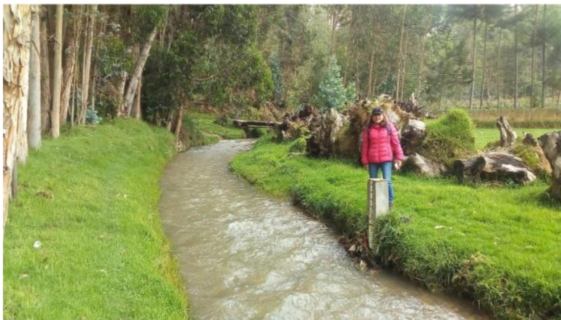
Figura 115: Mira limnimétrica del río Anya. Nótese el tipo de flujo subcrítico del río.
