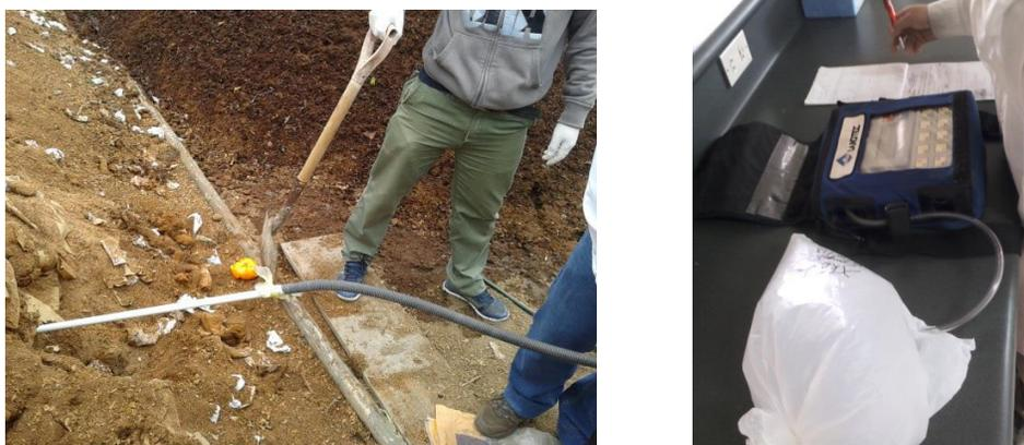
Figura 13: Muestreo de gases en pila de compost y posterior lectura en laboratorio
