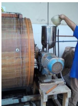
Figura 7: Adición de reactivo Tandestal Base y Tanplex FLA
