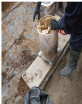
Figura 10: Pesado de contenedor pequeño con heces deshidratadas y material secante
