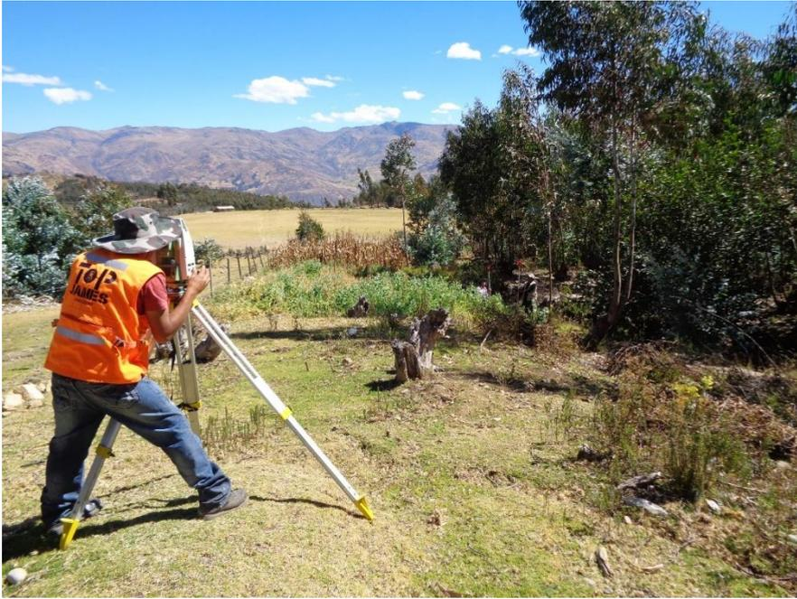
**Figura N° 13: Levantamiento topográfico con estación total - Aguas arriba de la zona de captación**
