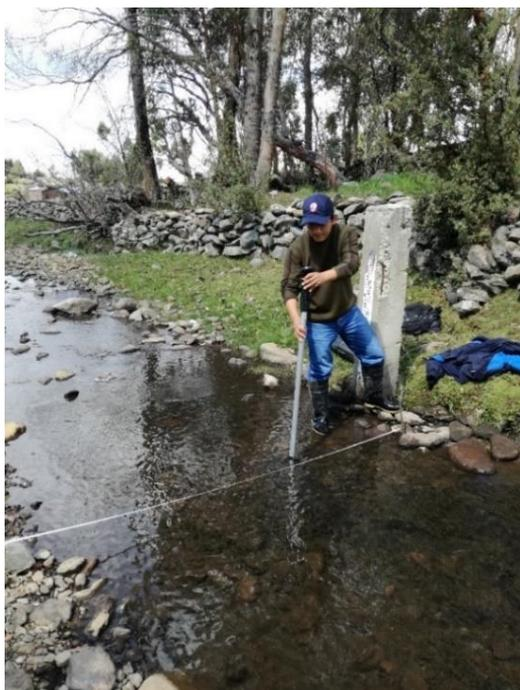
**Figura 17: Trabajo de aforamiento en quebrada Pampamarca**
