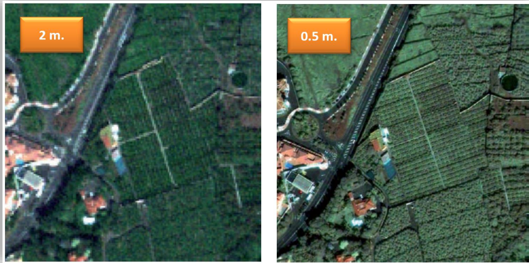
Figura 4: Comparación de dos imágenes con diferente resolución espacial (Fuente: Adaptado de SATELMAC, citado por Labrador García et al. 2012)
