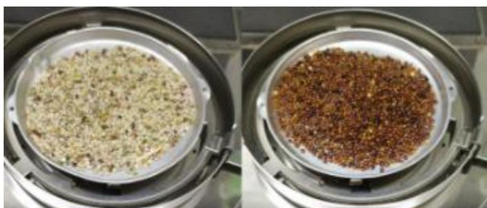
**Figura 15: Separación de defectos de color en quinua**
