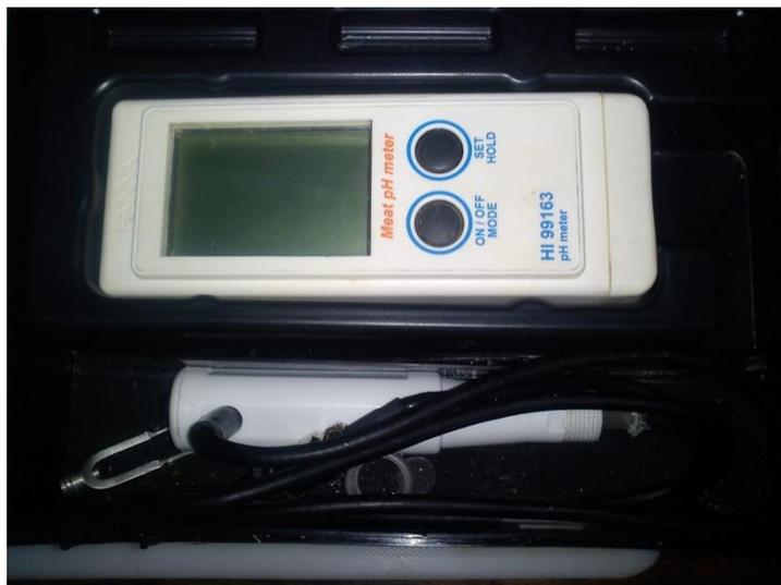
**Figura 9. Medidor de pH y temperatura para carne, marca HANNA.**
