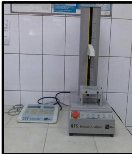
**Figura 7. Analizador de textura Brookfield® CNS Farnell QTS-25.**
