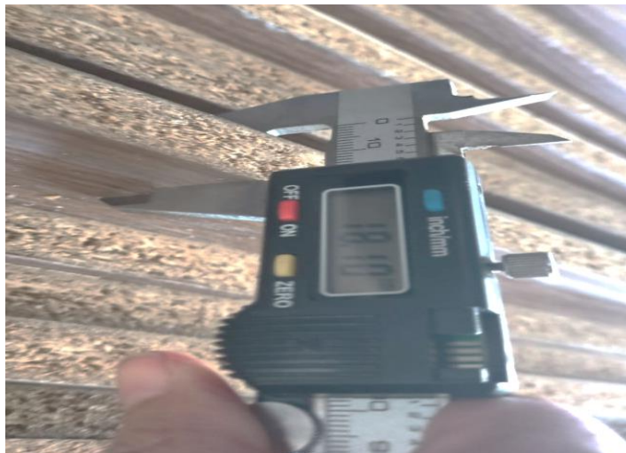
Figura N° 6 Medición del espesor del tablero usando el vernier.
