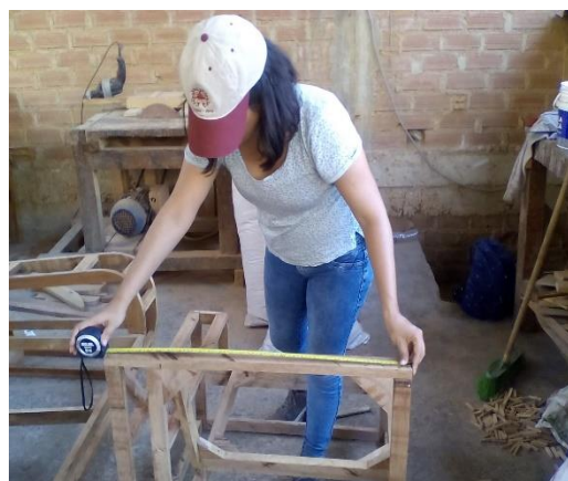
Medición de estructura de Sofá
