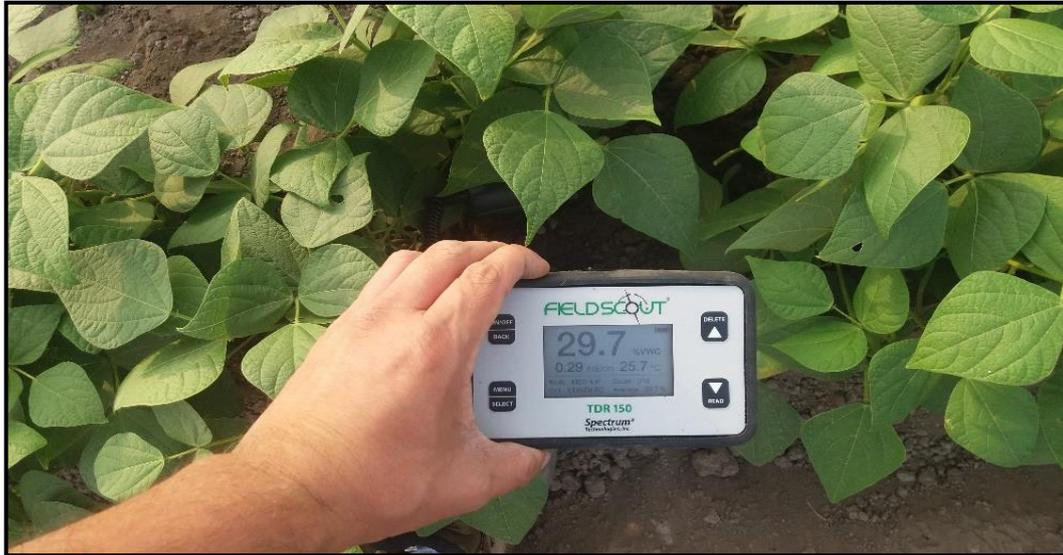
**Figura 24: Medición de la humedad del suelo del cultivo de frijol**
