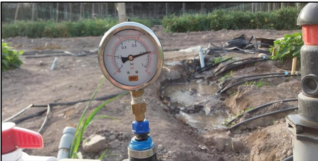
Verificación de presiones en arcos de riego para un riego uniforme.
