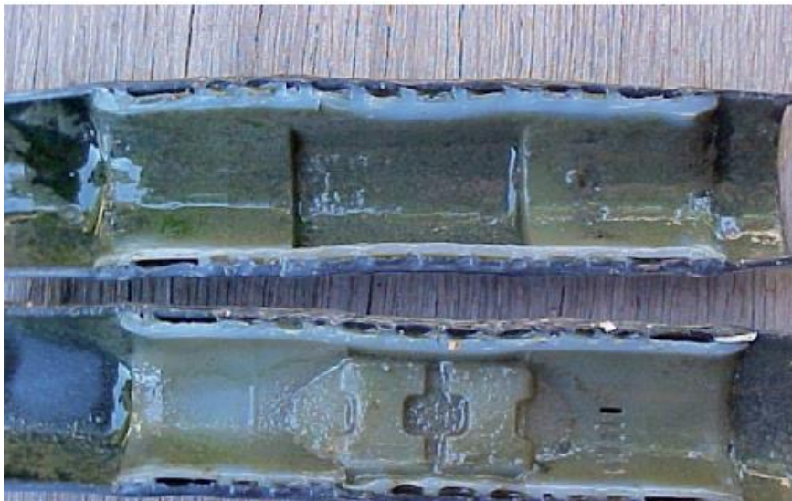
Figura 40: Góteros taponeados por precipitación.
