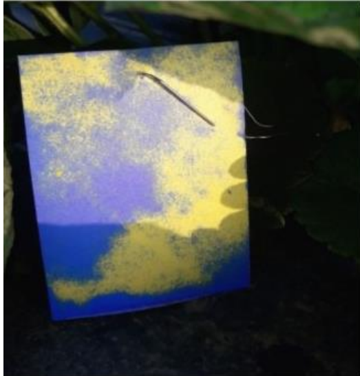
Figura 29: Mala cobertura en aplicaciones
