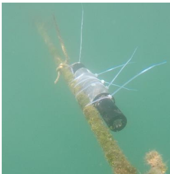
Figura 12. Registrador de datos “Datta Logger” (HOBO U26-001) instalado a 3m de profundidad en Long line.
