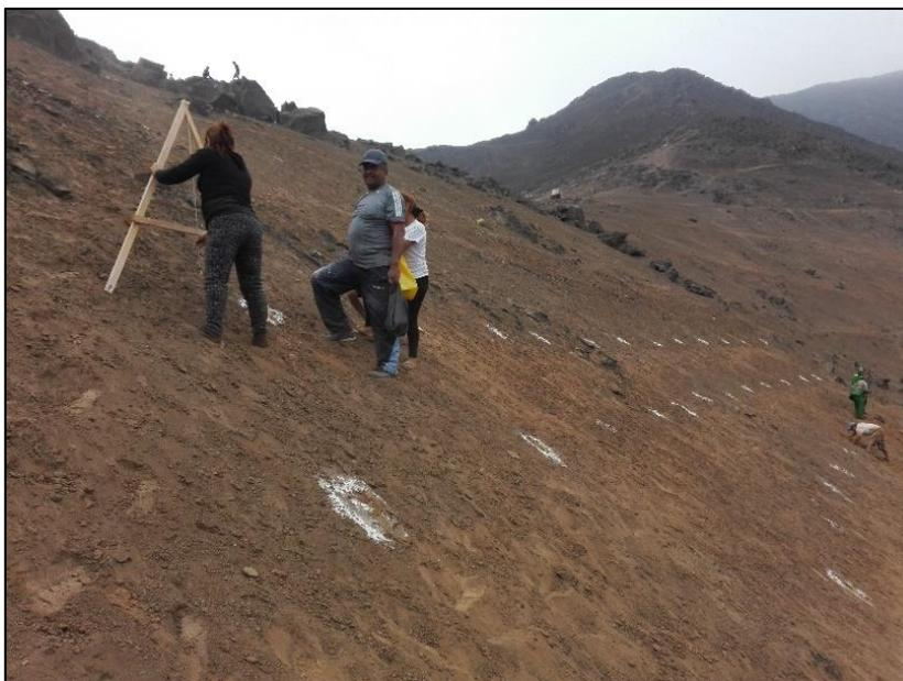
**Figura 7:** Diseño de plantación en curvas de nivel usando el nivel A
