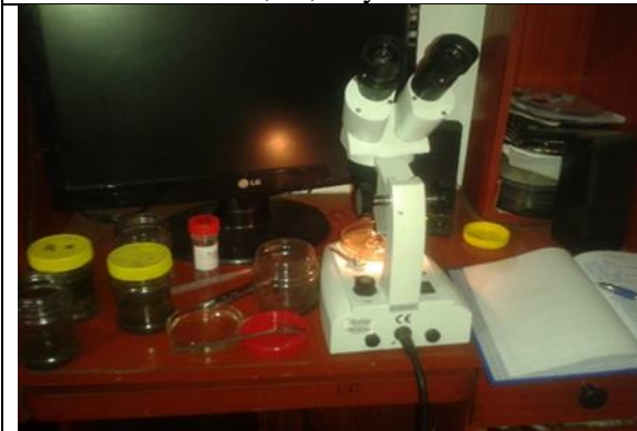
Foto 41. Evaluación de muestras, determinación, conteo y registro de individuos. Separación de individuos en frascos de 10 ml.
