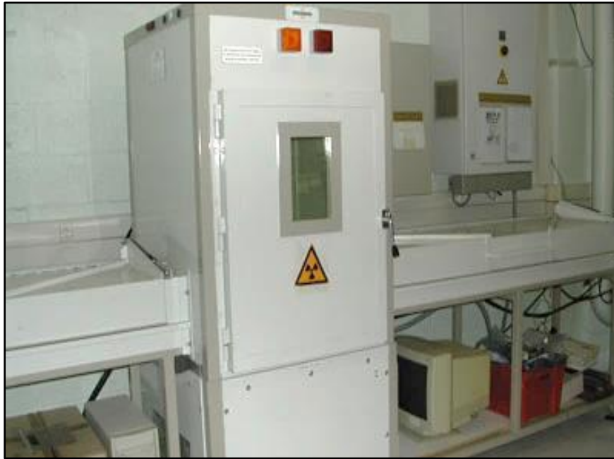
Figura 37: Sistema de radiografías digital SCOPIX del laboratorio EPOC en la Universidad de Bordeaux, Francia.
