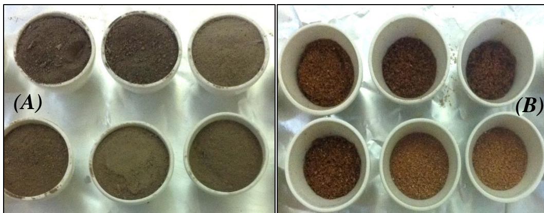
Figura 39: Muestras antes (A) y después (B) del proceso de pérdida por ignición.
