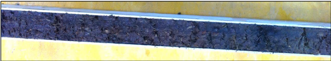
Figura 36: Sección de la placa extraída de una de las mitades longitudinales del testigo POR1 para el análisis de densidad aparente.
