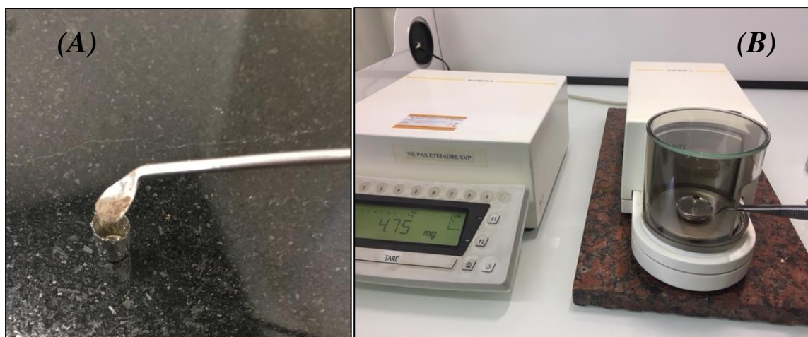
Figura 40: Depósito de muestras trituradas a cápsulas de estaño (A) y pesado de muestras encapsuladas para análisis (B).
