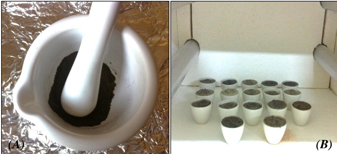
Figura 38: Mezcla de muestras pulverizadas en un mortero (A) y dentro del horno mufla antes del proceso de pérdida por ignición (B).
