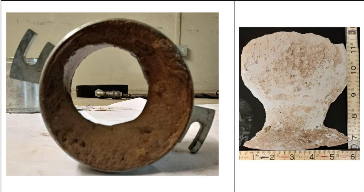
Figura 109. M-06 limo inorgánico ligeramente plástico (ML) después del ensayo de tubificación.
