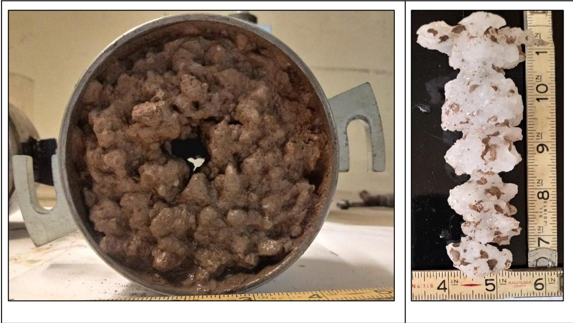
Figura 63. M-01 arcilla inorgánica medianamente plástica (CH) después del ensayo de tubificación.
