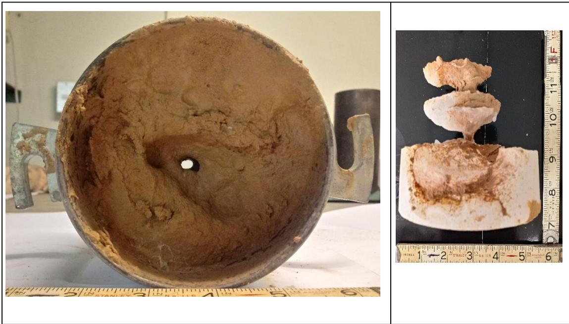
Figura 97. M-13 arcilla inorgánica medianamente plástica (CL) después del ensayo de tubificación.
