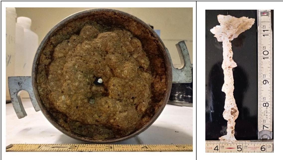
Figura 111. M-07 limo inorgánico medianamente plástico (ML) después del ensayo de tubificación.
