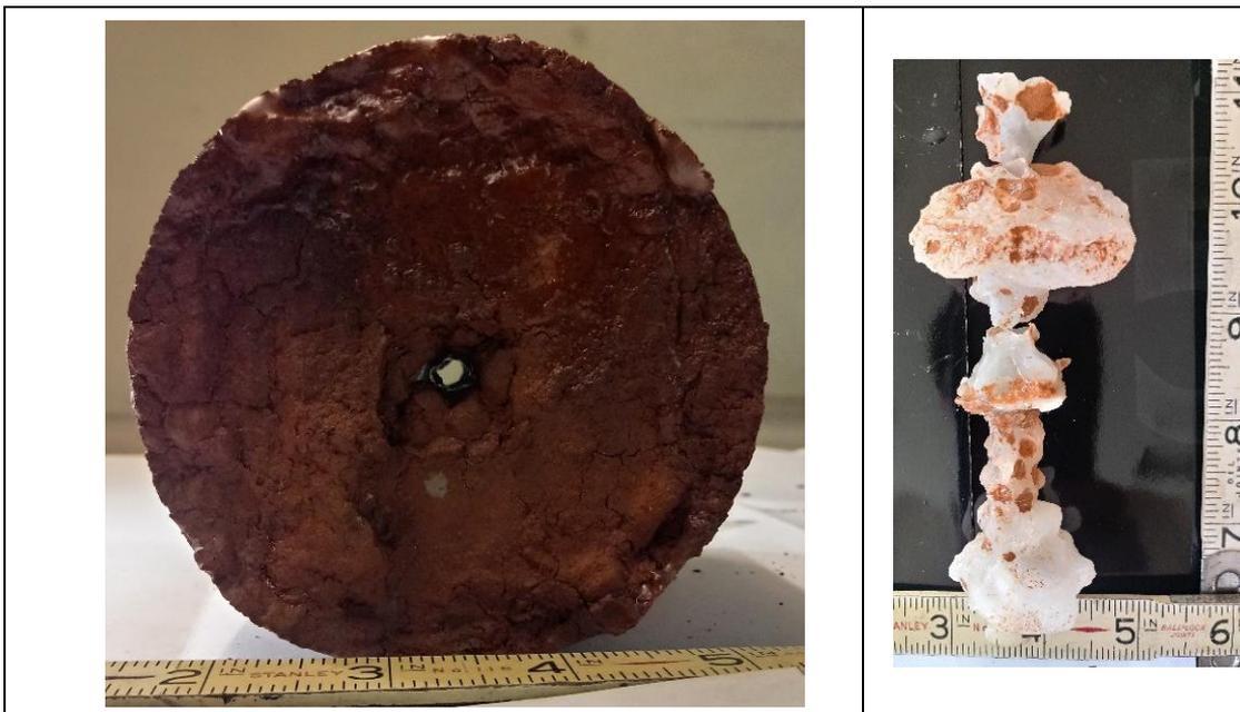
Figura 69. M-21 arcilla inorgánica muy plástica (CH) después del ensayo de tubificación.
