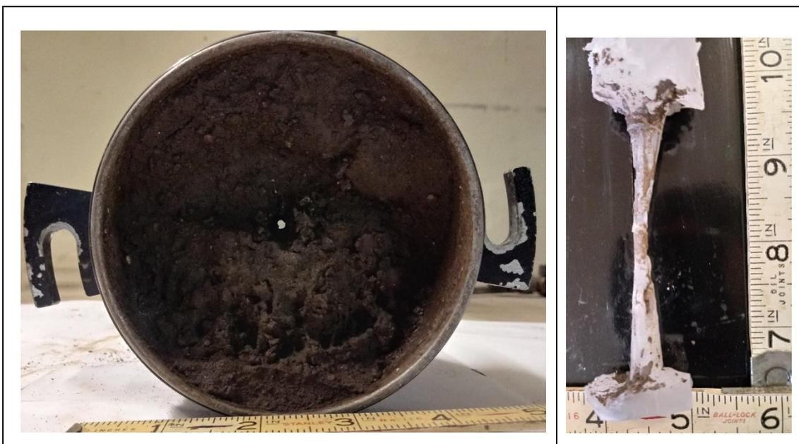
Figura 73. M-16 arcilla inorgánica medianamente plástica (CL arenoso) después del ensayo de tubificación.
