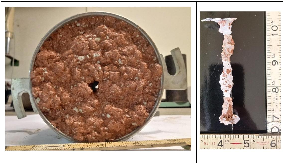
Figura 67. M-19 arcilla inorgánica muy plástica (CH) después del ensayo de tubificación.
