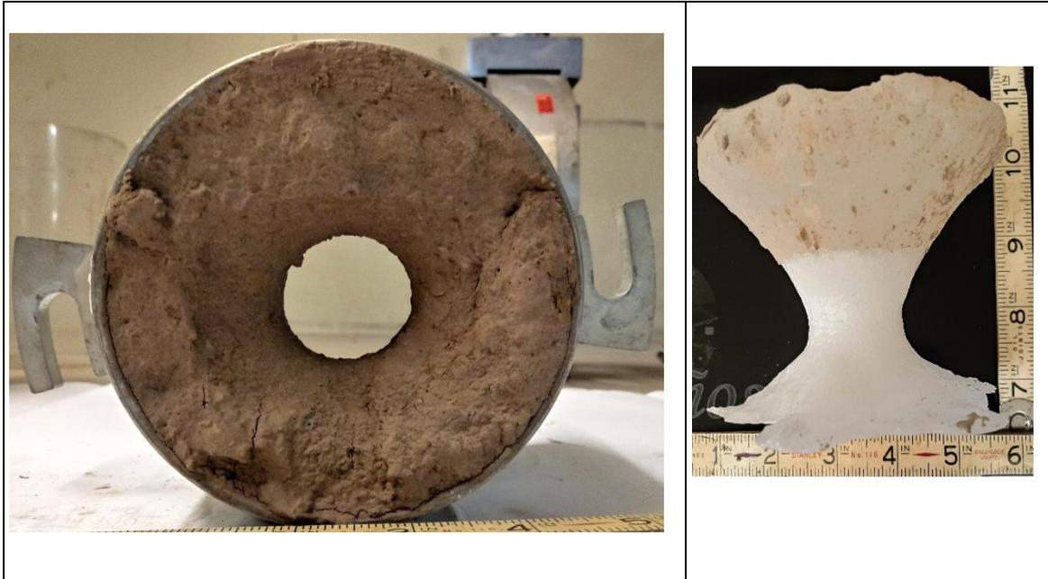
Figura 107. M-05 limo inorgánico ligeramente plástico (ML) después del ensayo de tubificación.
