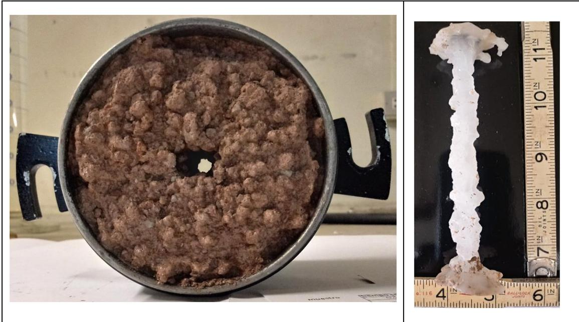
Figura 61. M-15 arcilla inorgánica muy plástica (CH) después del ensayo de tubificación.
