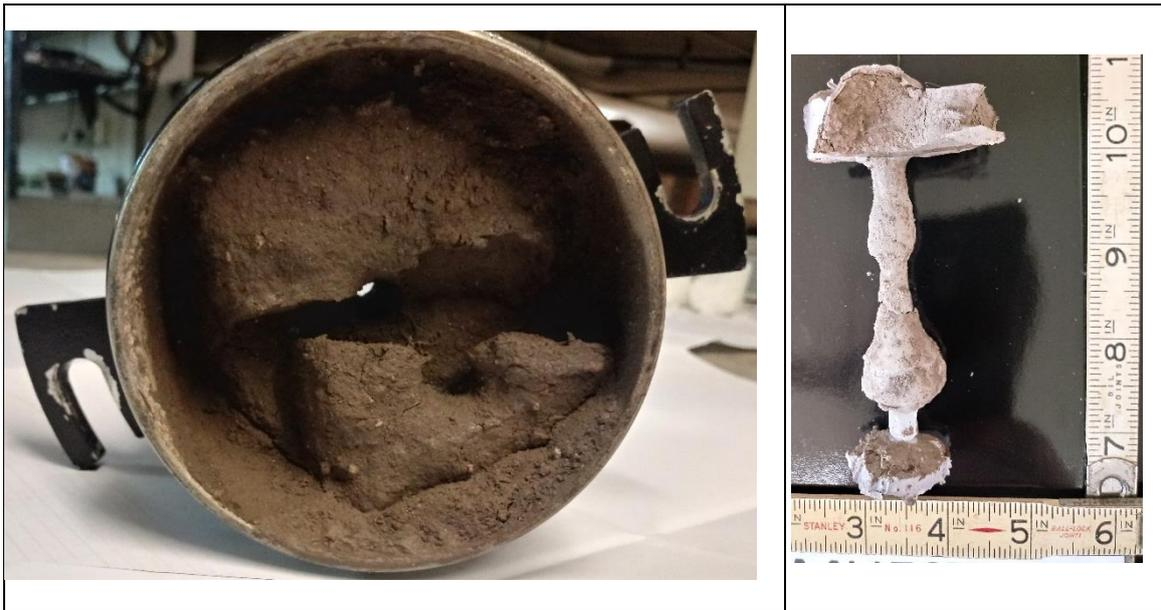
Figura 83. M-27 arcilla inorgánica ligeramente plástica (CL arenoso) después del ensayo de tubificación.
