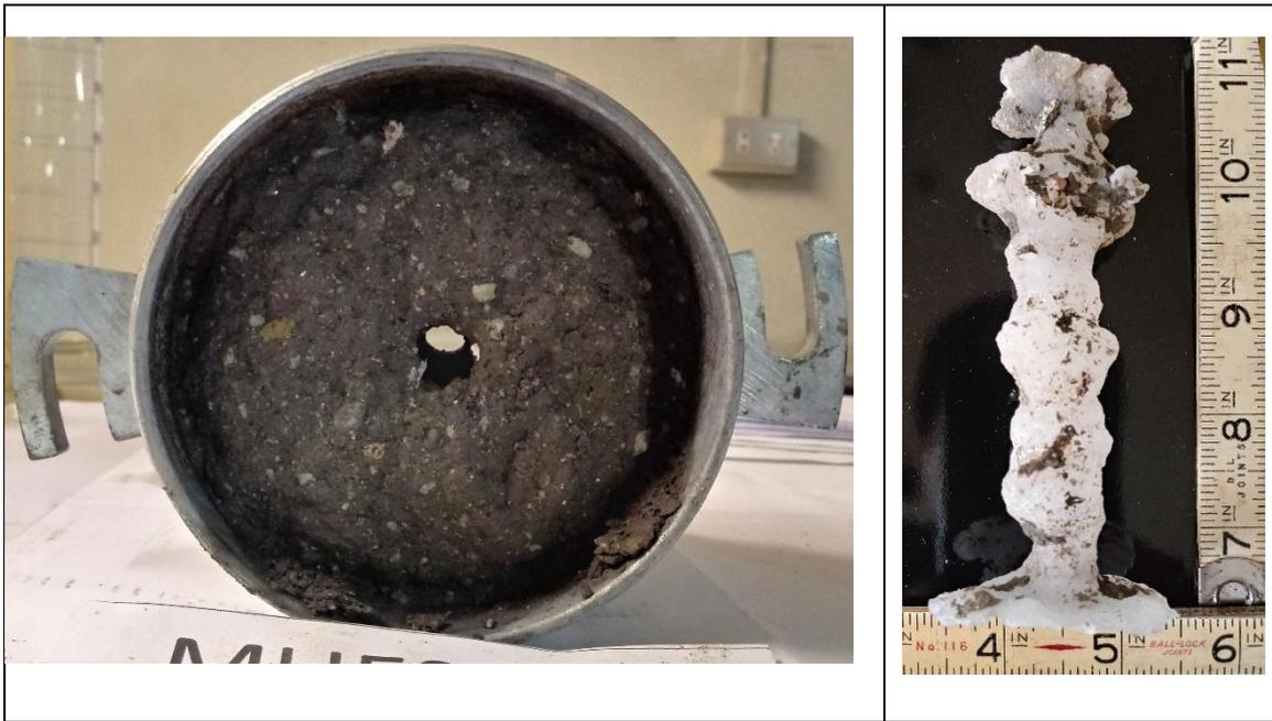
Figura 79. M-24 arcilla inorgánica medianamente plástica (CL arenoso) después del ensayo de tubificación.
