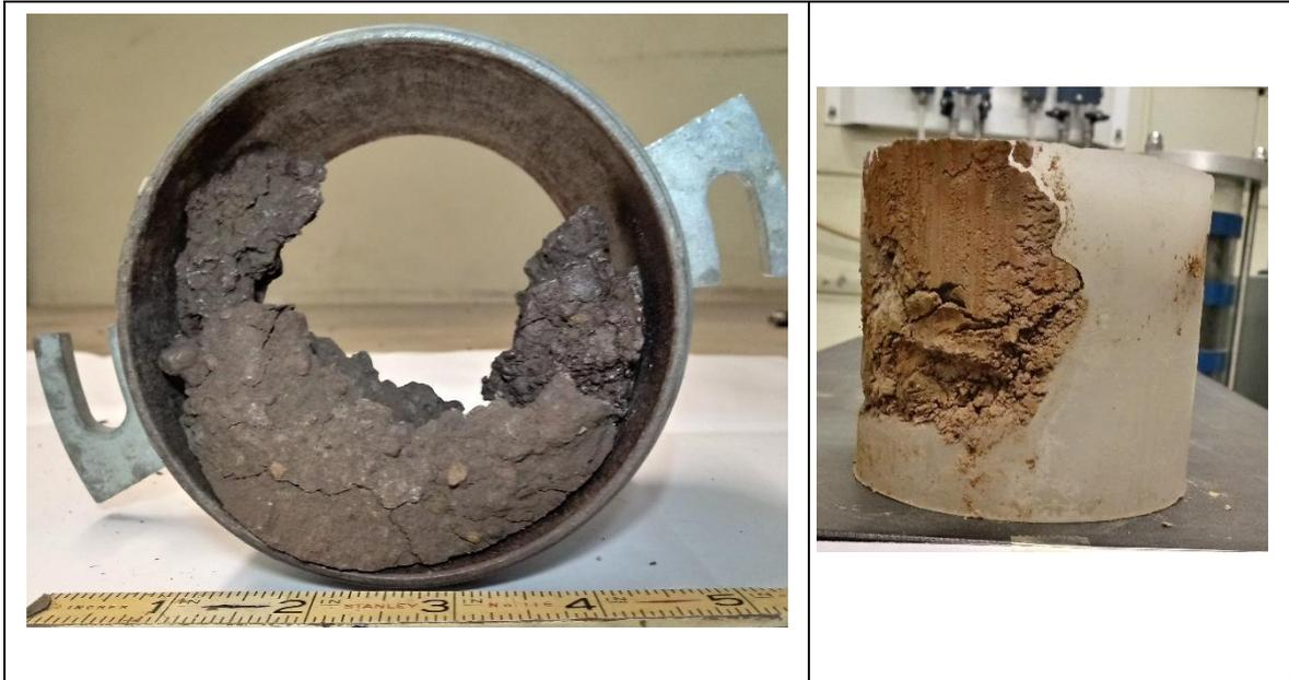
Figura 89. M-02 arcilla inorgánica medianamente plástica (CL) después del ensayo de tubificación.
