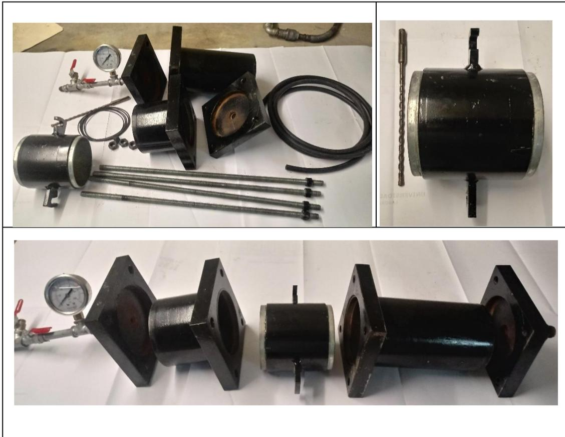
Figura 34. Celdas para el ensayo de tubificación.
