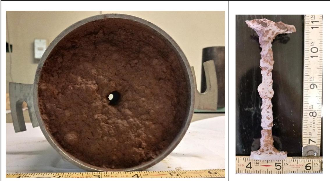
Figura 95. M-10 arcilla inorgánica medianamente plástica (CL) después del ensayo de tubificación.
