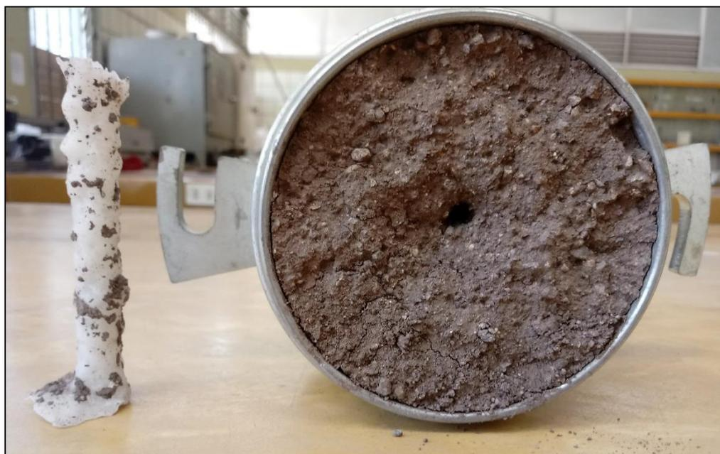
Figura 41. Aspecto final del orificio formado de una prueba (derecha) y plantilla de orificio de parafina (izquierda).
