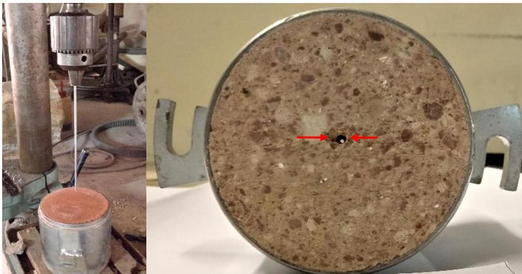
Figura 38. Perforación de la muestra con una broca de 3 milímetros de diámetro.
