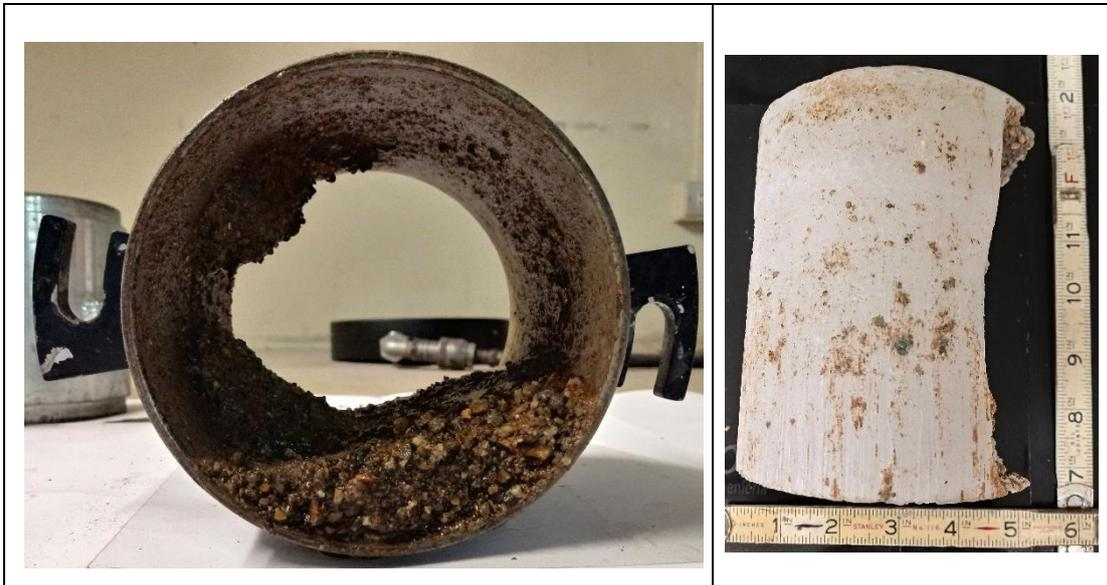
Figura 115. M-025 arena limosa no plástica (SM) después del ensayo de tubificación.
