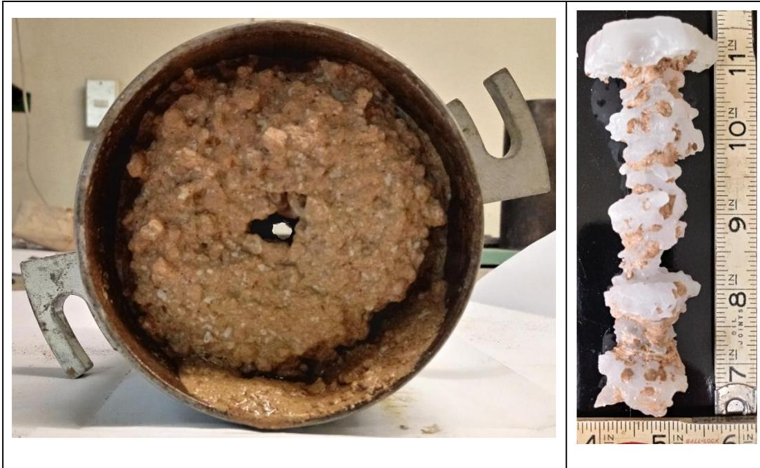
Figura 87. M-20 arcilla inorgánica ligeramente plástica (CL) después del ensayo de tubificación.
