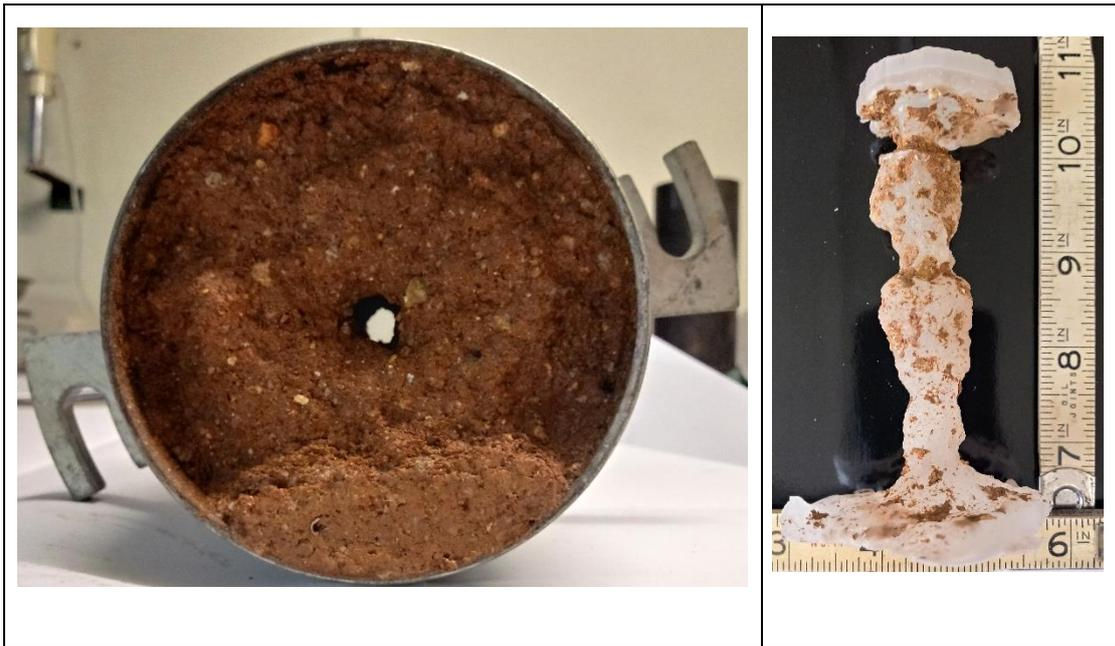
Figura 81. M-26 arcilla inorgánica medianamente plástica (CL arenoso) después del ensayo de tubificación.
