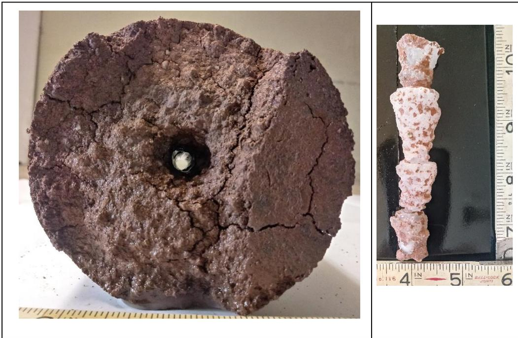
Figura 77. M-22 arcilla inorgánica medianamente plástica (CL arenoso) después del ensayo de tubificación.
