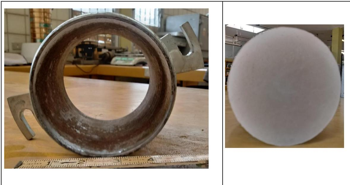
Figura 113. M-09 limo inorgánico medianamente plástico (ML) después del ensayo de tubificación.
