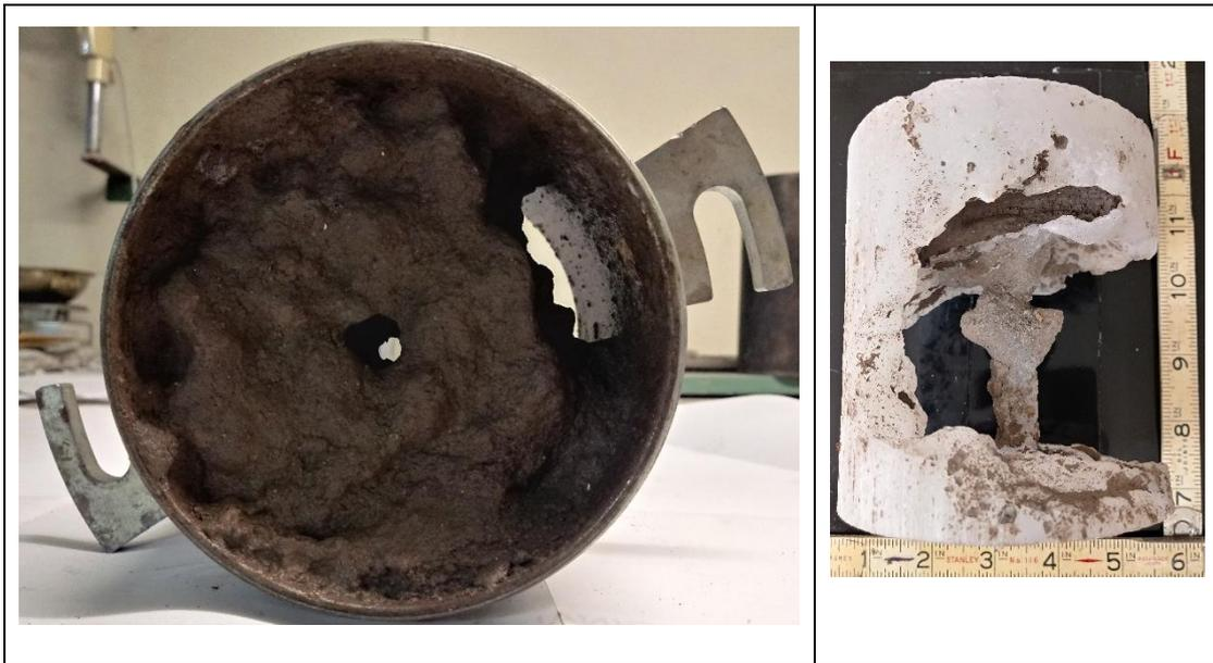
Figura 85. M-28 arcilla inorgánica ligeramente plástica (CL arenoso) después del ensayo de tubificación.
