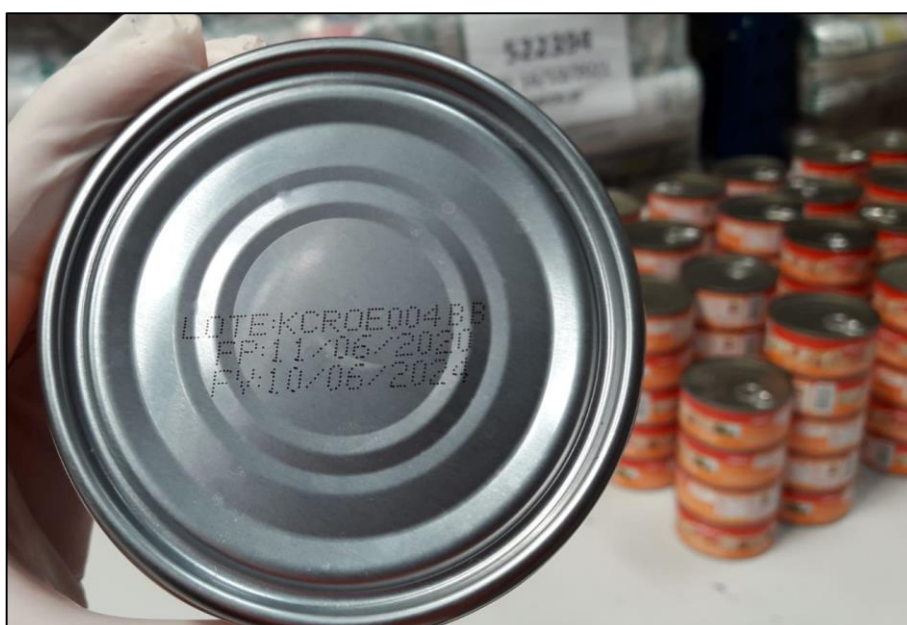
Figura 30: Codificación de la lata clara y legible
