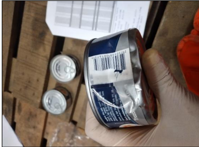
Figura 15: Conserva de pescado con defectos de abolladura en el cuerpo de la lata
