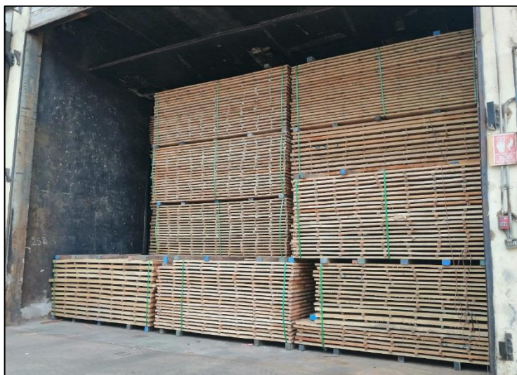
Figura 5. Cámara de secado
