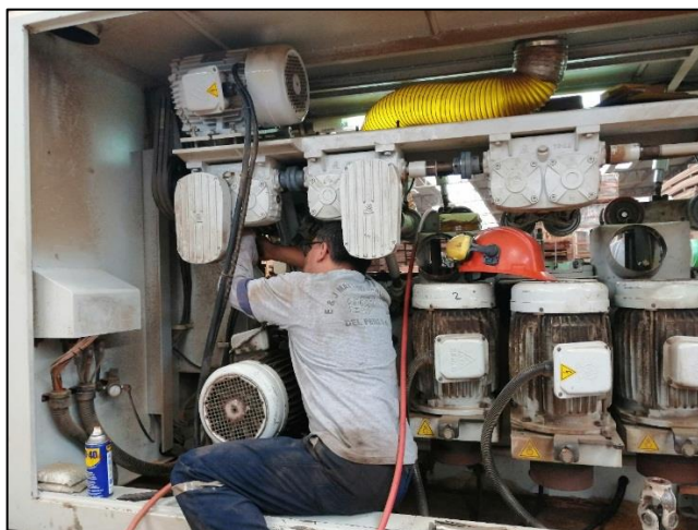
Figura 16. Personal técnico realizando mantenimiento de la moldurera.
