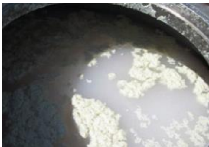
Figura N° 6 Incompatibilidad de productos en campo (precipitados).
