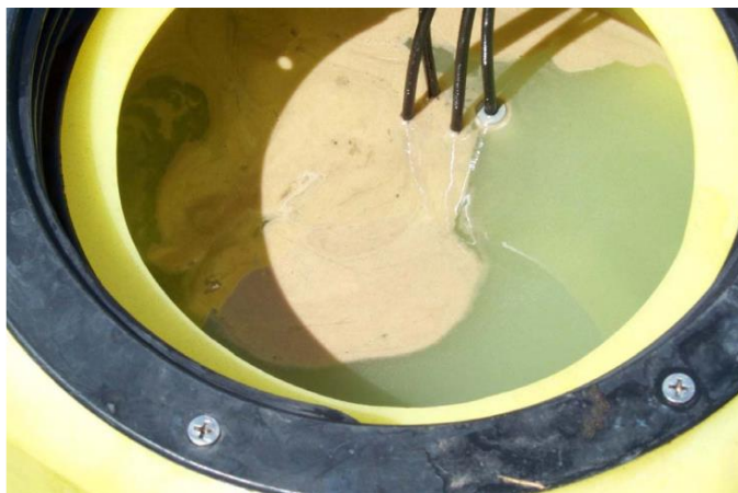
Figura N° 7 Incompatibilidad de productos en campo (capa oleosa).
