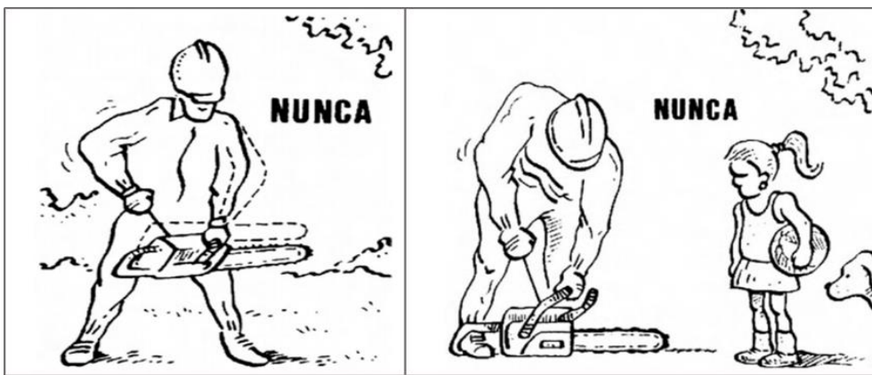
Figura 18. Forma incorrecta de utilizar la motosierra
