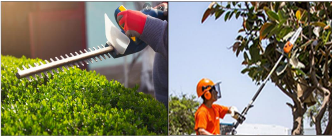
Figura 17. Cortadora multiusos (izq. cortadora de setos, der. podadora de altura)
