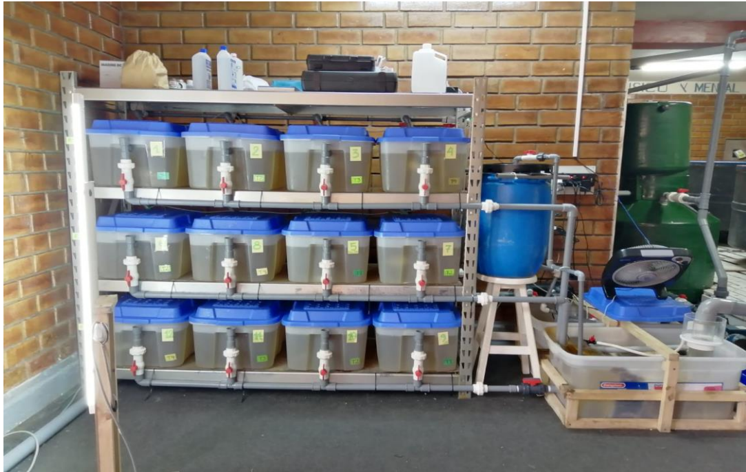
Figura 11: Sistema de recirculación experimental de la tesis
