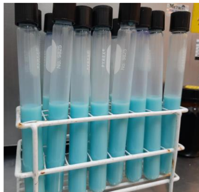
Figura 13: Leche con azul de metileno después de agitación.
