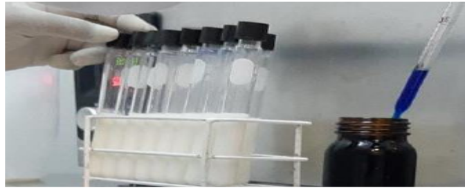
Figura 11: Adición de azul de metileno.
