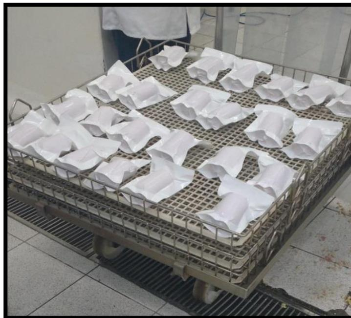
**Figura 7:** Colocación de los moldes en bolsas pouche en las bandejas
