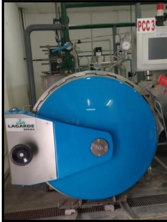
**Figura 6:** Autoclave con contrapresión marca Lagarde
