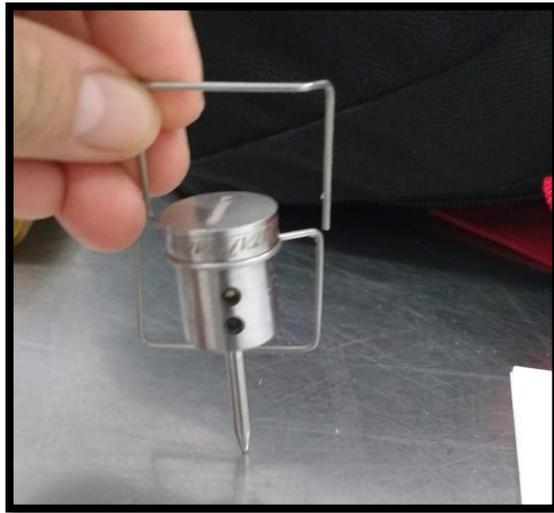
**Figura 2:** Sensor de temperatura inalámbrica
