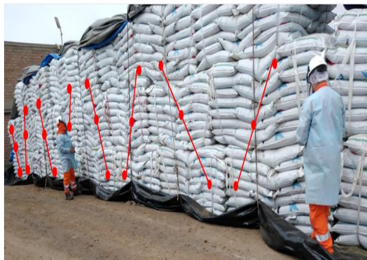
Figura 19: Puntos de muestreos para análisis microbiológico (MB), en la planta TASA – Callao
