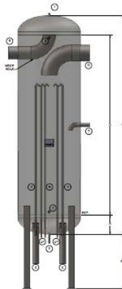
Figura 16. Tanque recirculador de líquido
