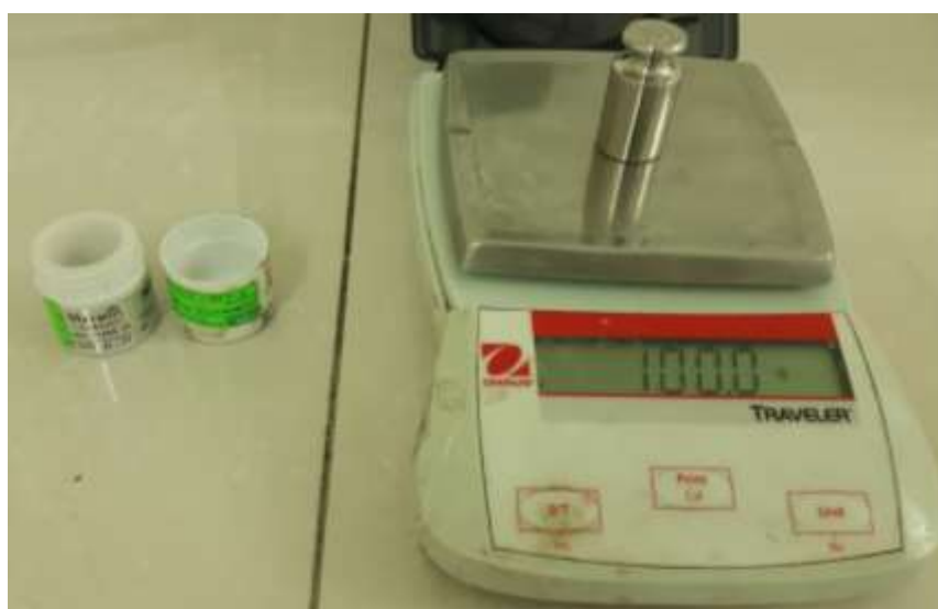
Figura 7. Verificación de la Balanza Mediante el Uso de Pesas Patrón
