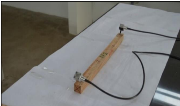
Figura 10 : Evaluación equipo Ultrasonic Timer .Fuente : INIA 2018, proyecto 121
