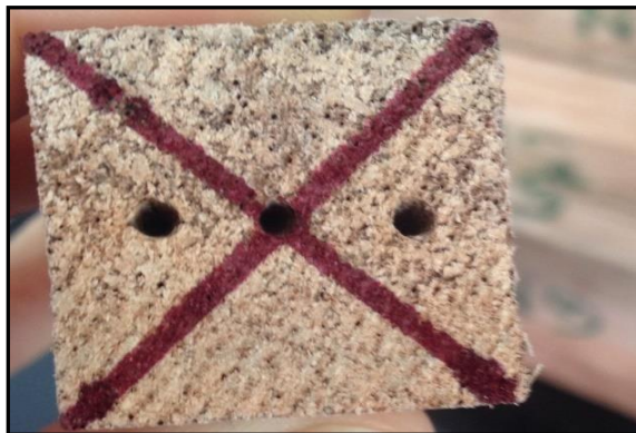
Figura 7: Posiciones en cara transversal de la probeta en evaluación con Microsecond Timer. Fuente: INIA 2018, proyecto 121
