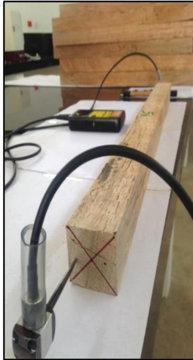
Figura 8: Evaluación con Microsecond timer. Fuente: INIA 2018, proyecto 121
