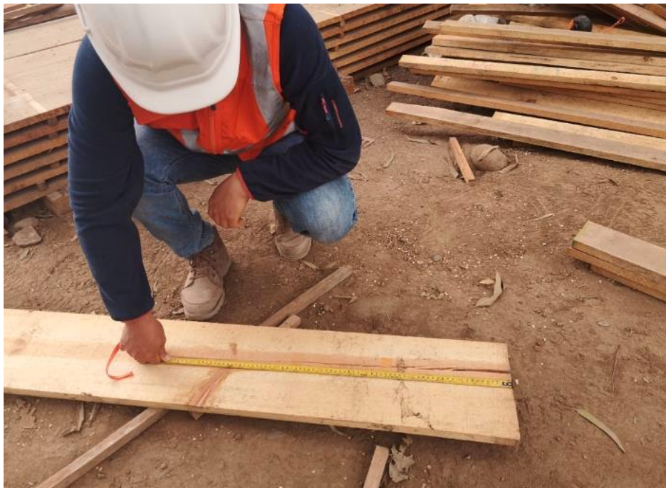
Cubicación y evaluación de calidad de las piezas aserradas
