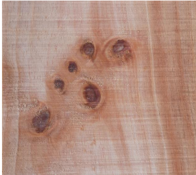
Figura 2: Presencia de nudos arracimados en una pieza de madera de Pinus tecunumanii
