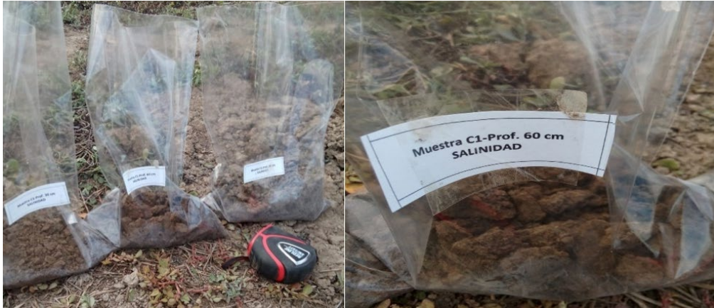
Figura 11: Vistas de la toma de muestras del suelo de las calicatas
